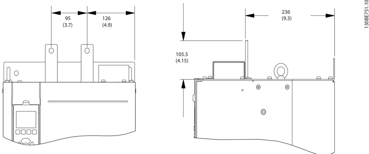
图 7.5 直流母线尺寸（正视图和侧视图）
