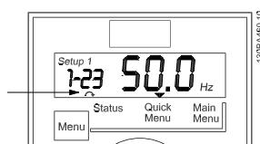
图 3.7 表示电动机方向
