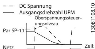
Abbildung 3.51 Geregelte Rampe ab, längerer Netzausfall
