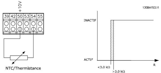
Illustration 3.14 Connexion de la thermistance PTC - entrée analogique
