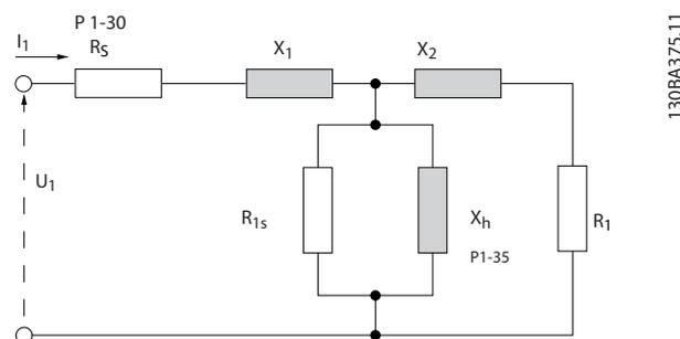
Illustration 3.4 Schéma moteur équivalent pour un moteur asynchrone
