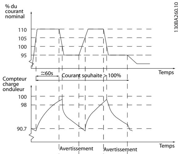
Illustration 3.55 Courant de sortie en condition de surcharge
