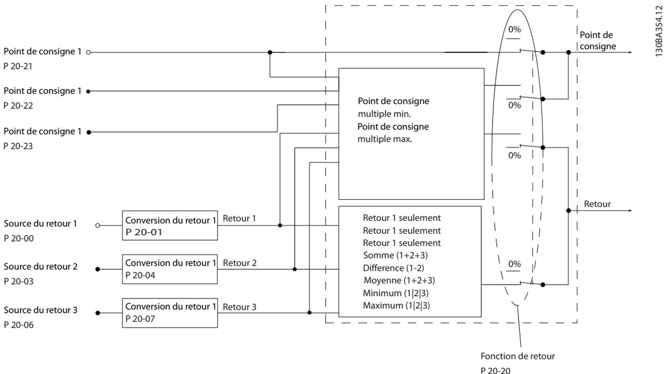
Illustration 3.60 Signaux d'entrée du régulateur PID en boucle fermée
