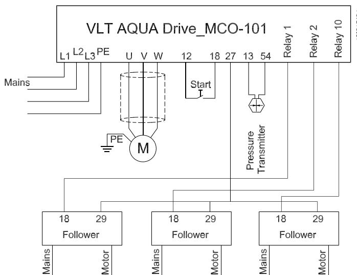
Εικόνα 8.2: Ηλεκτρική καλωδίωση. Ο ακροδέκτης 27 στον κύριο ρυθμιστή στροφών χρησιμοποιείται ως τιμή αναφοράς της παλμικής εξόδου. Ο ακροδέκτης 29 των δευτερεύοντων ρυθμιστών στροφών χρησιμοποιείται ως τιμή αναφοράς της παλμικής εισόδου. Όλοι οι δευτερεύοντες ρυθμιστές στροφών συνδέονται στο δίκτυο ρεύματος και στον κινητήρα με τον ίδιο τρόπο που συνδέεται ο κύριος ρυθμιστής στροφών, ο οποίος συμβολίζεται με το κείμενο: *Δίκτυο ρεύματος και κινητήρας*.
