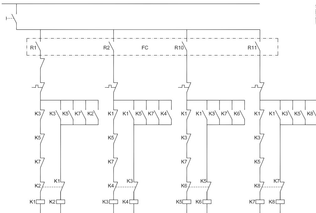
Εικόνα 3.1: Κύκλωμα ελέγχου εναλλασσόμενης κύριας αντλίας (4 αντλίες).
