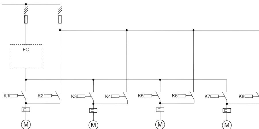
Εικόνα 3.2: Κύκλωμα δικτύου ρεύματος εναλλασσόμενης κύριας αντλίας (4 αντλίες).
