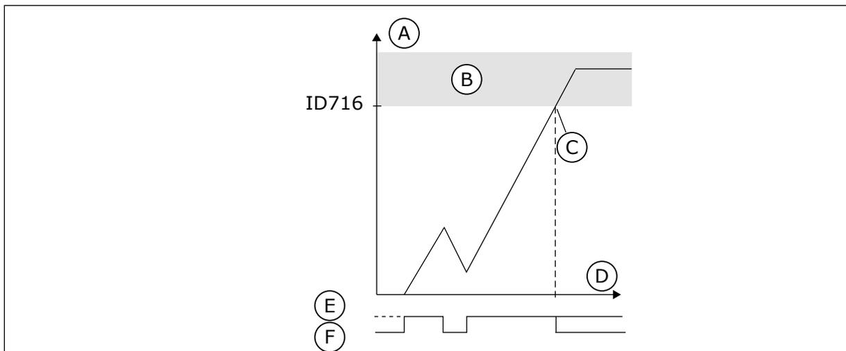
Fig. 70: Fonction de compteur de temporisation de sous-charge
