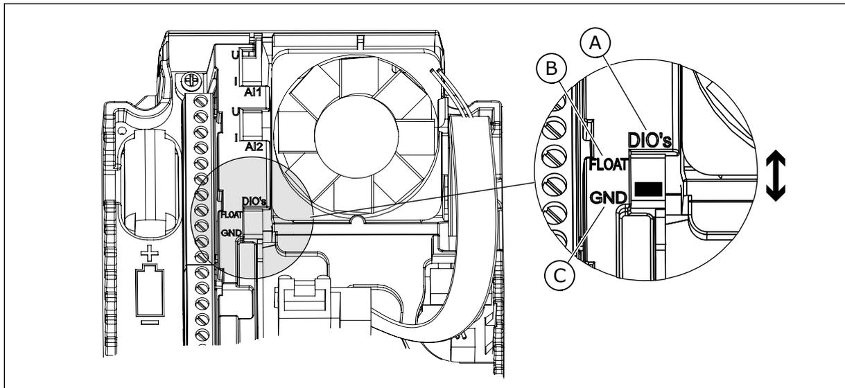
Fig. 5: Interrupteur DIP
