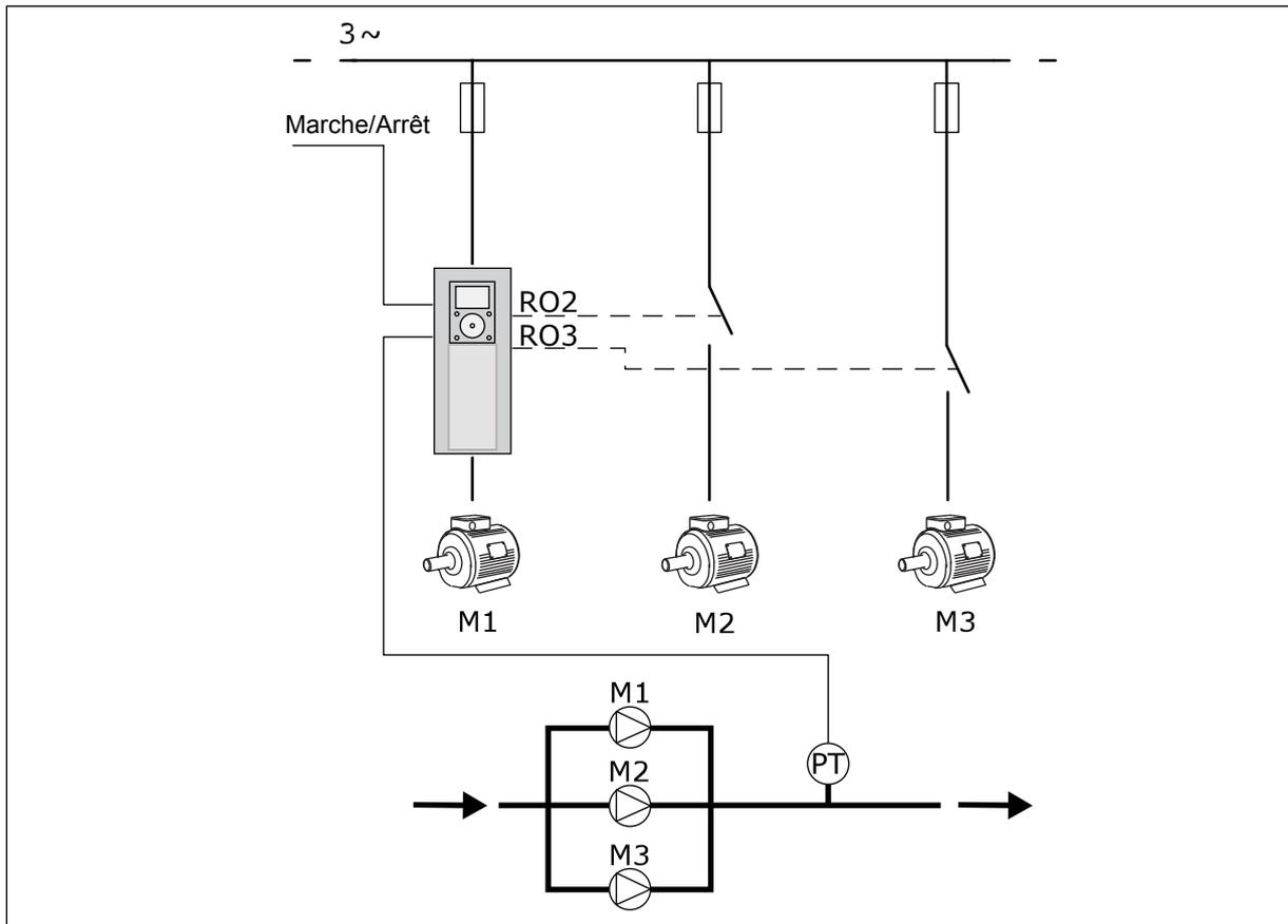
Fig. 8: Configuration multi-pompes (convertisseur de fréquence unique)
