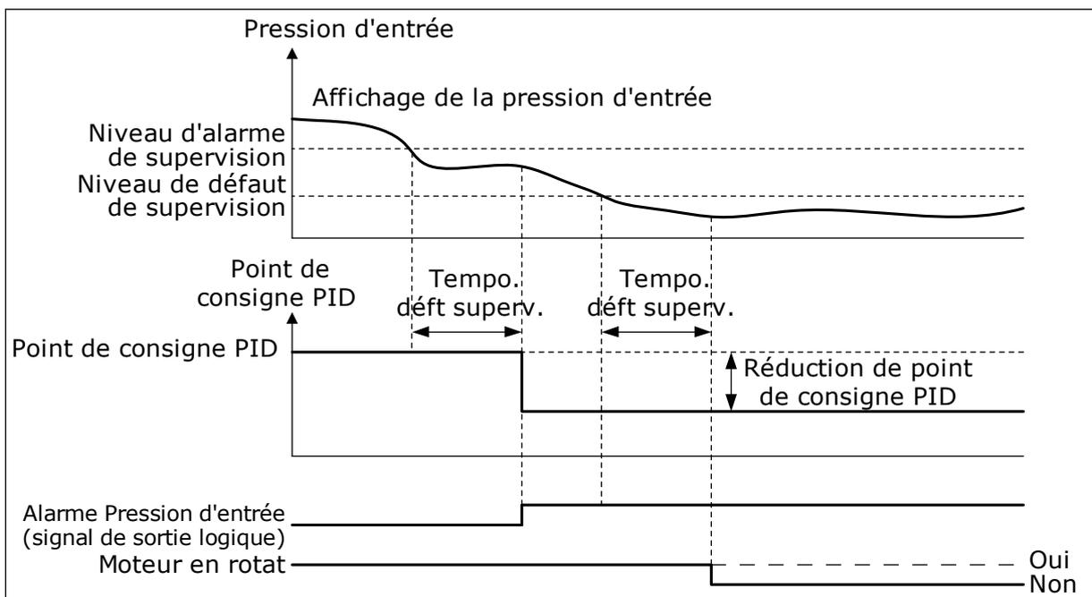
Fig. 87: Fonction de supervision de la pression d'entrée
