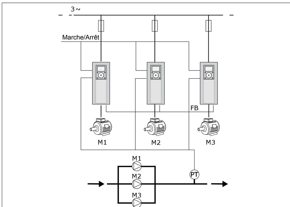
Fig. 13: Configuration multi-pompes (convertisseurs de fréquence multiples)
