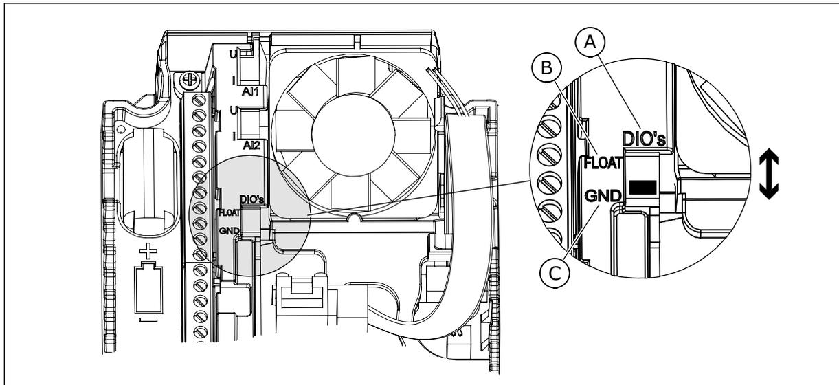
Fig. 17: Interrupteur DIP
