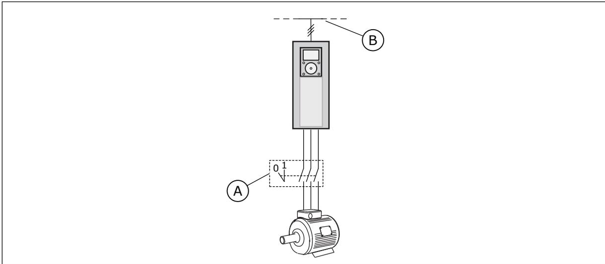
Fig. 36: Interrupteur moteur entre le convertisseur et le moteur
