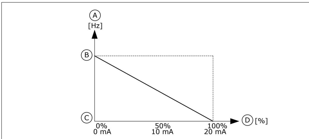
Fig. 61: Inversion du signal AI1, sélection 1
