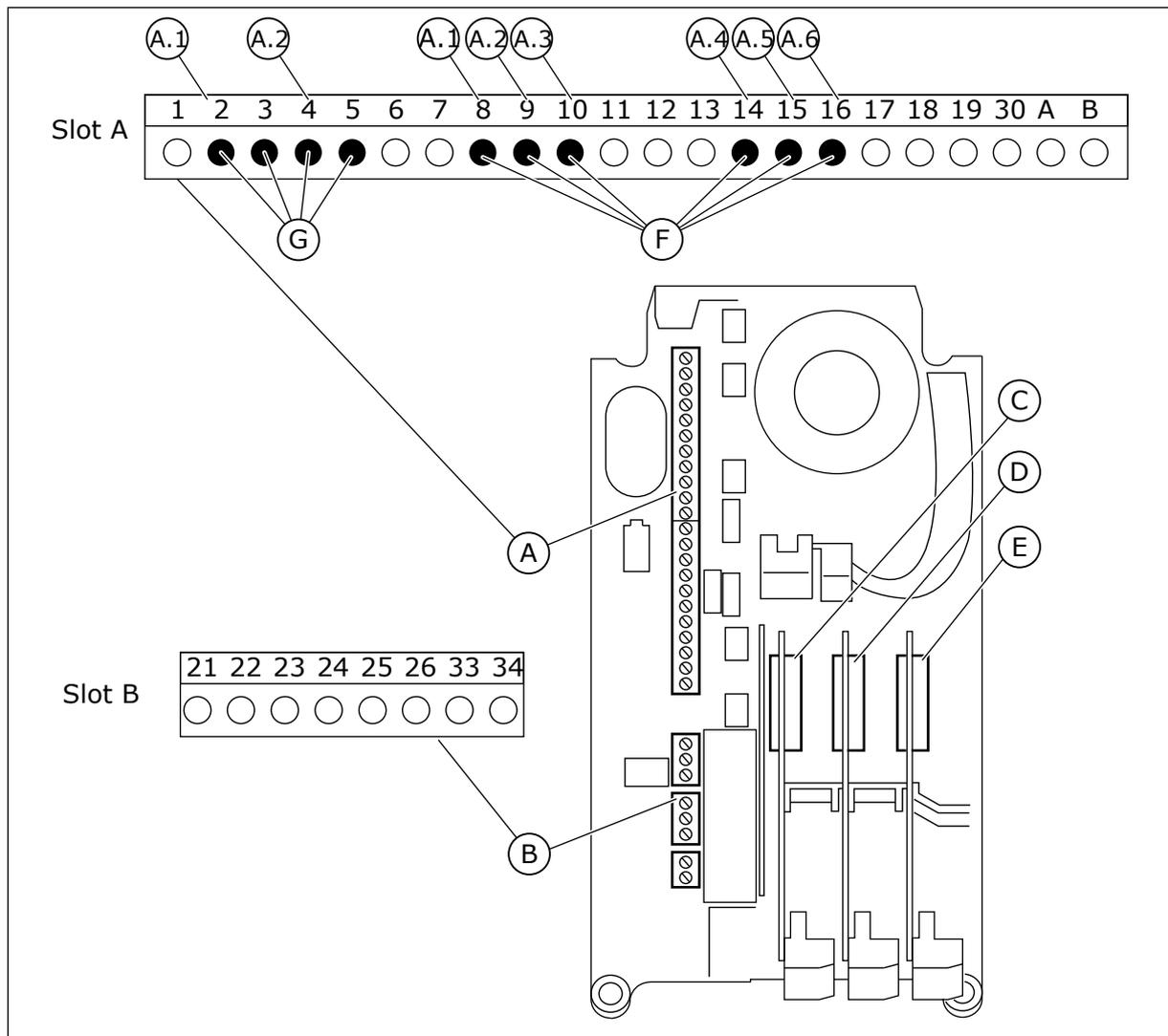
Fig. 51: Emplacements des cartes optionnelles et entrées programmables
