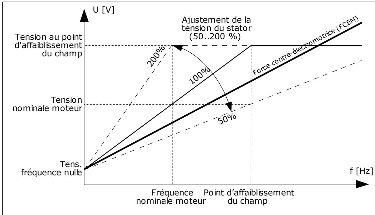
Fig. 37: Ajustement de la tension du stator
