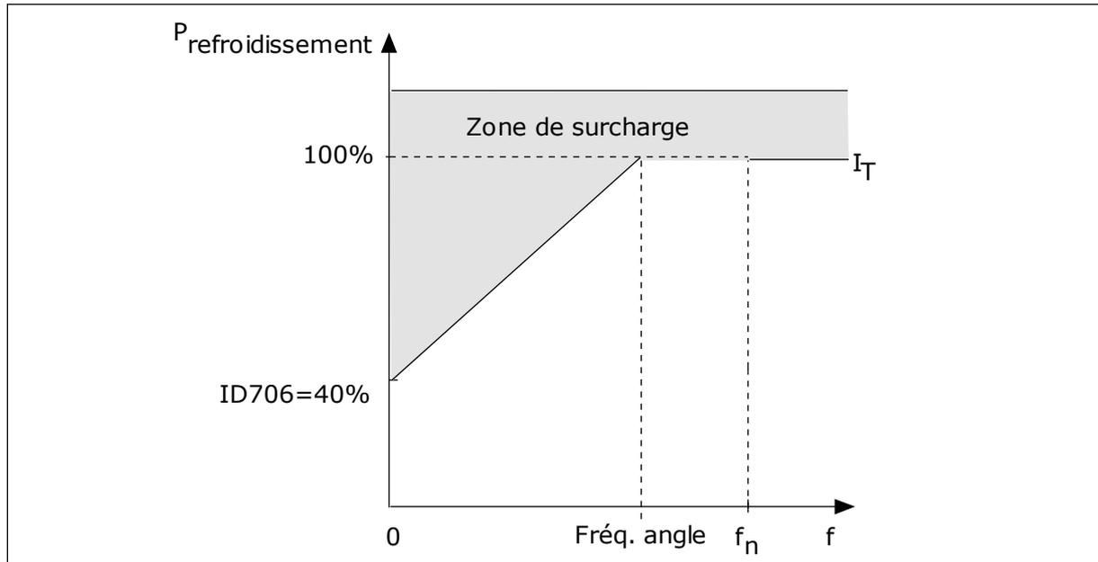
Fig. 65: Courbe de courant thermique  $I_T$  du moteur
