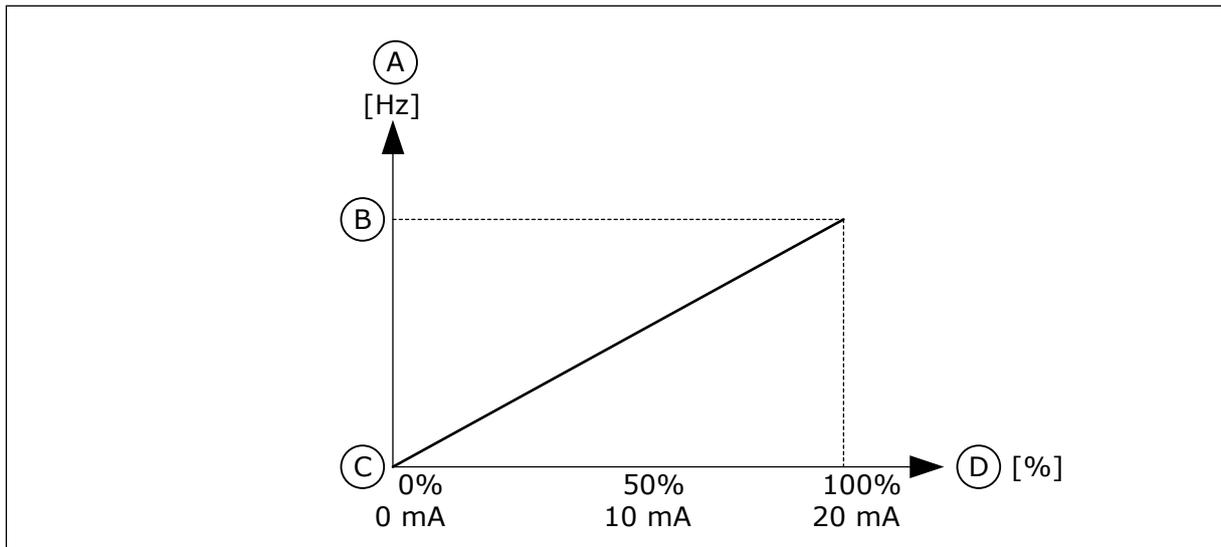
Fig. 57: Plage du signal d'entrée analogique, sélection 0
