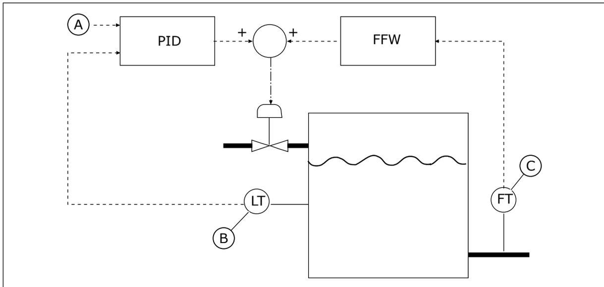
Fig. 80: Commande d'action directe
