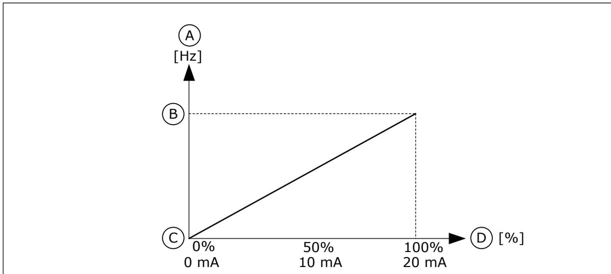
Fig. 60: Inversion du signal AI1, sélection 0
