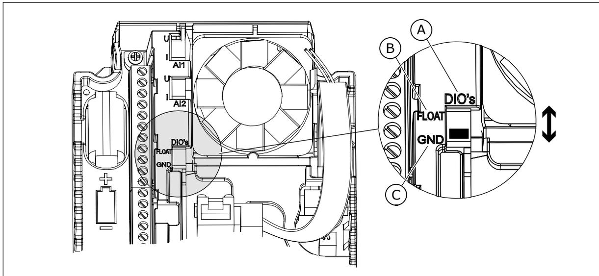
Fig. 12: Interrupteur DIP
