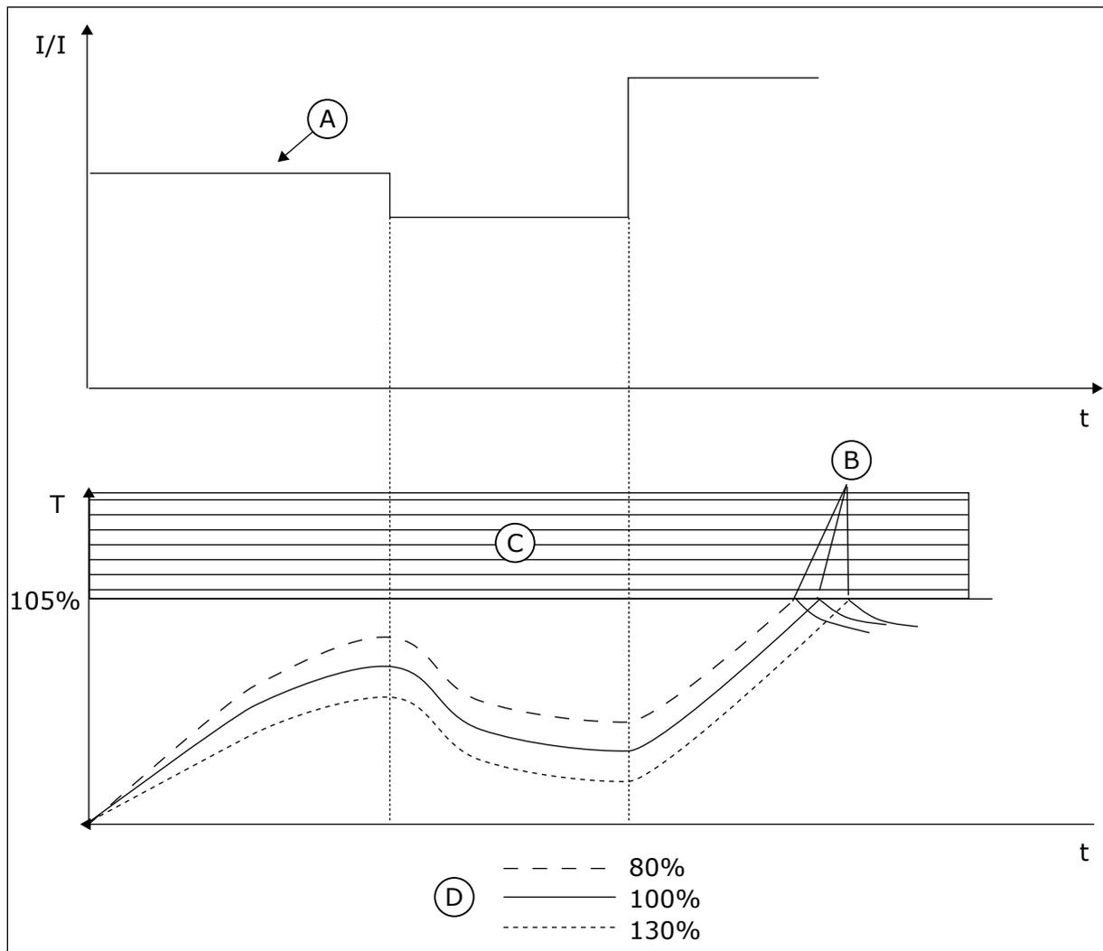
Fig. 67: Calcul de la température du moteur
