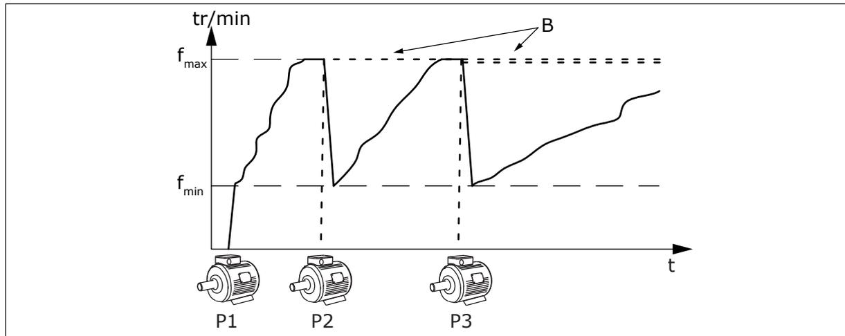
Fig. 91: Contrôle en mode Convertisseur de fréquence unique
