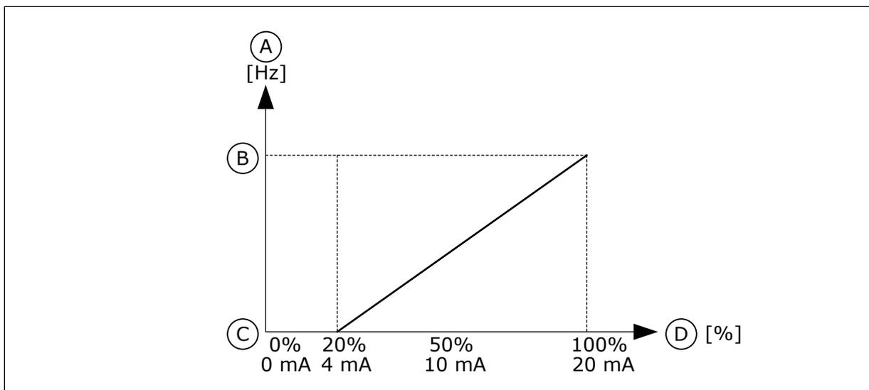
Fig. 58: Plage du signal d'entrée analogique, sélection 1
