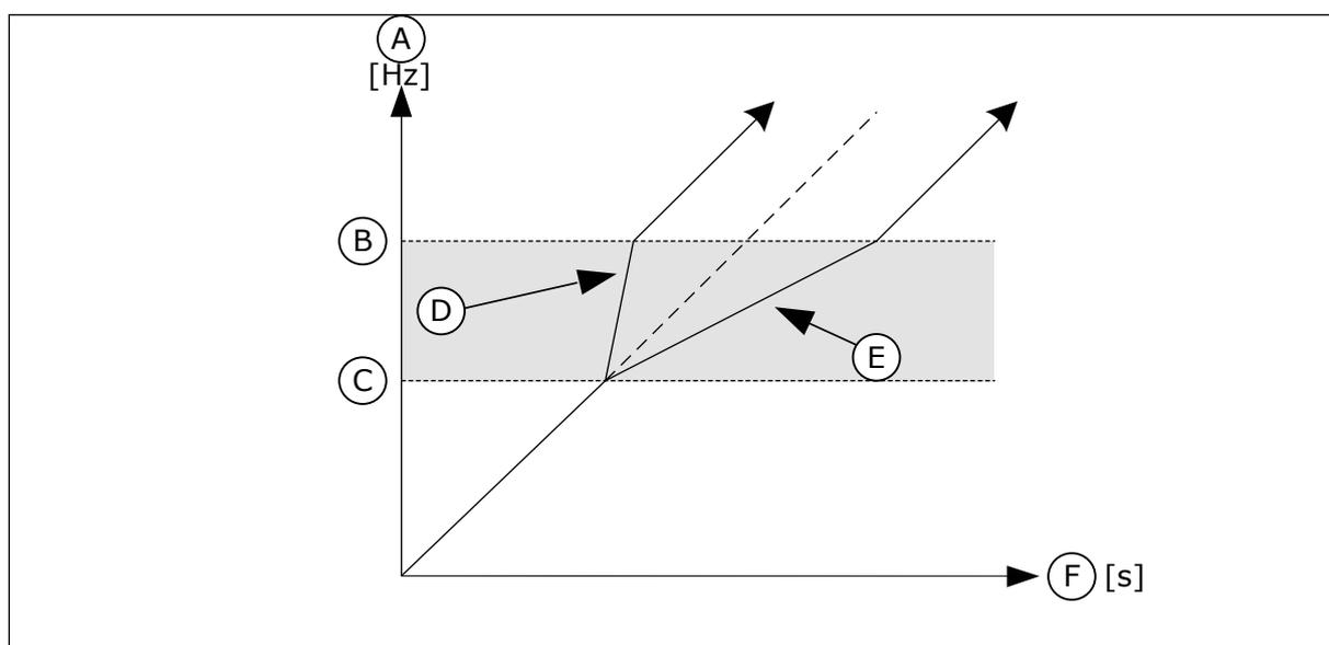
Fig. 64: Paramètre Facteur de temps de rampe
