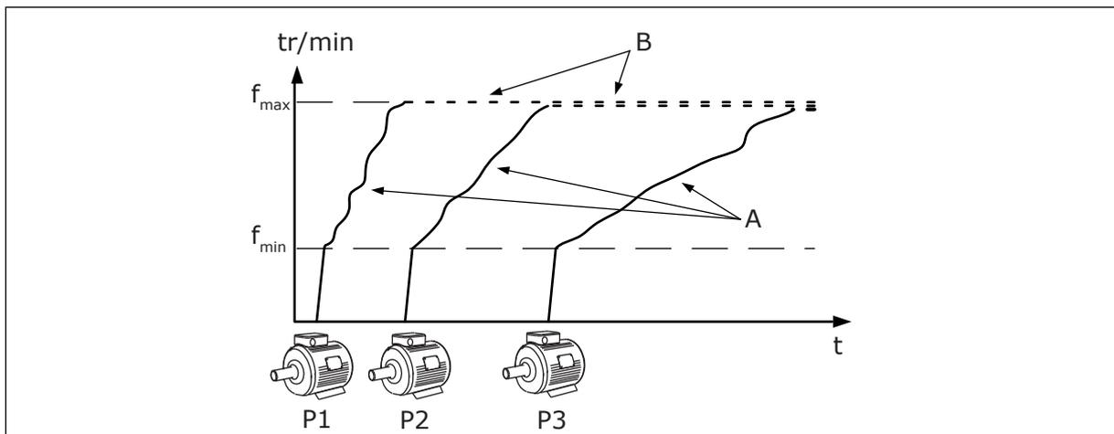
Fig. 93: Commande en mode Multimaster
