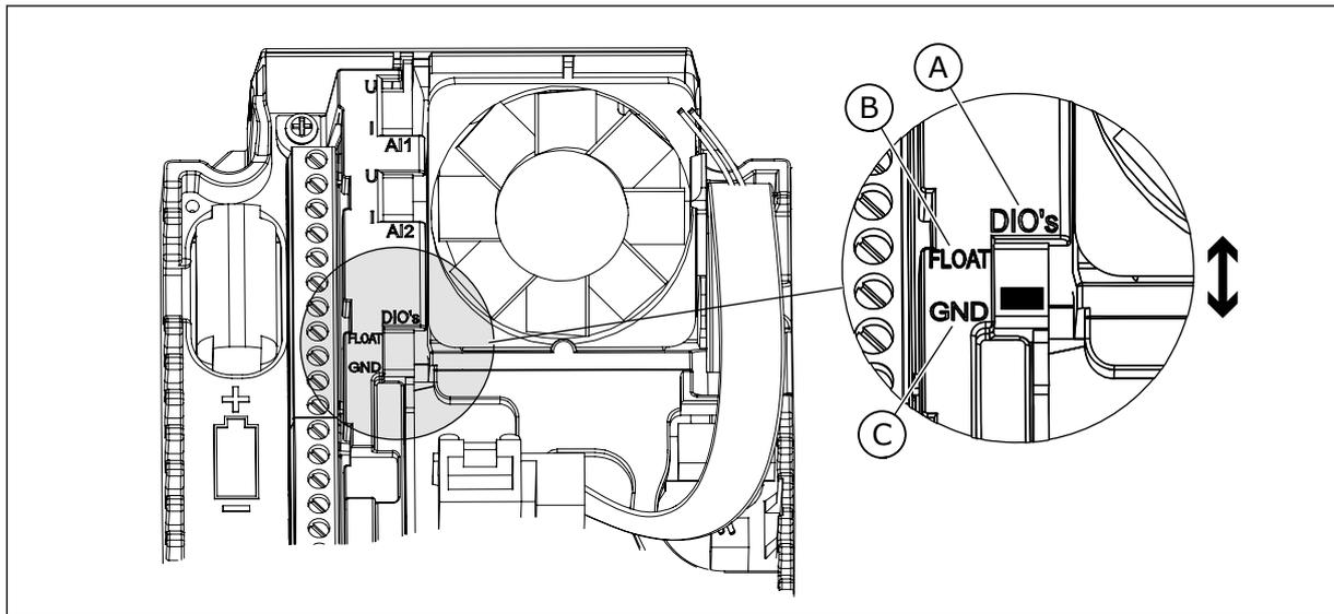
Fig. 7: Interrupteur DIP
