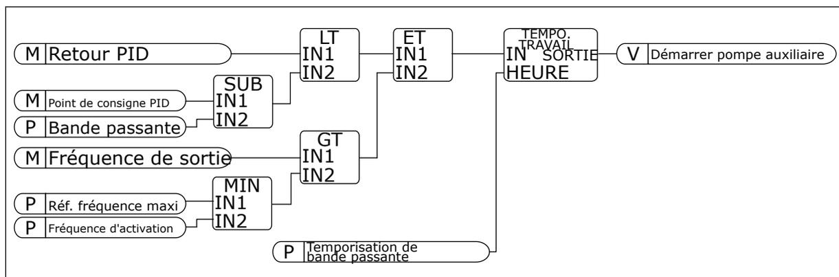
Fig. 101: Fréquence d'activation
