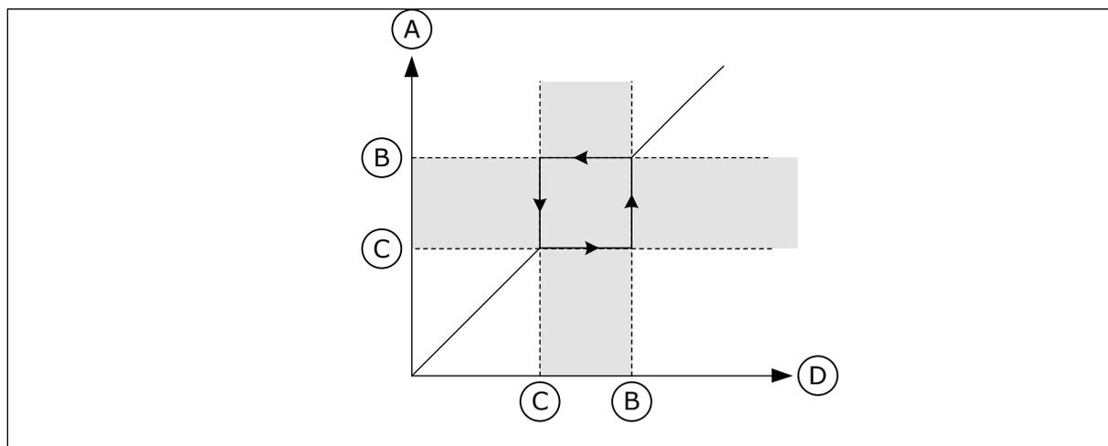
Fig. 63: Fréquences interdites
