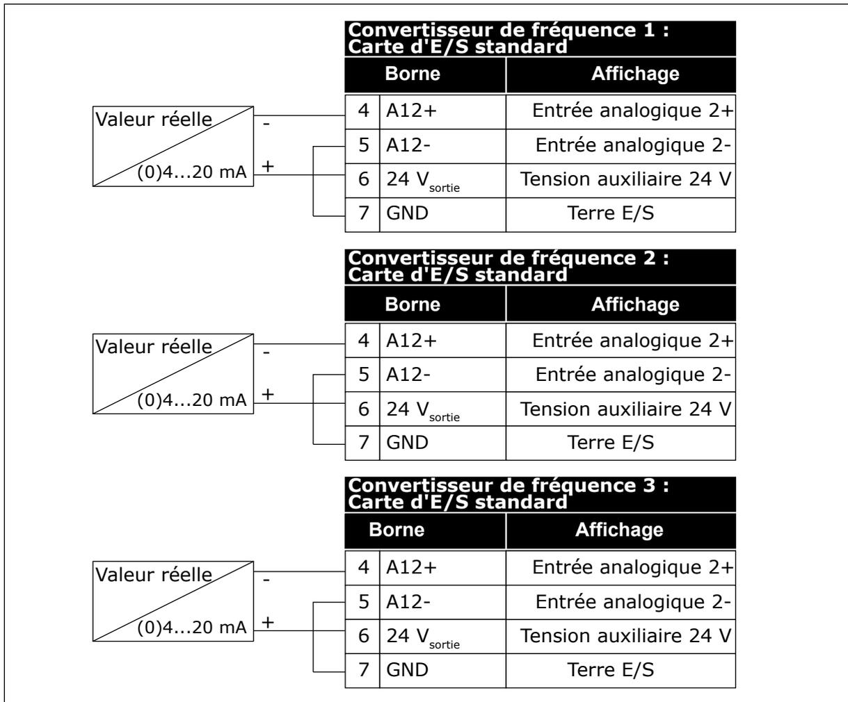
Fig. 94: Câblage des capteurs de retour pour chaque convertisseur
