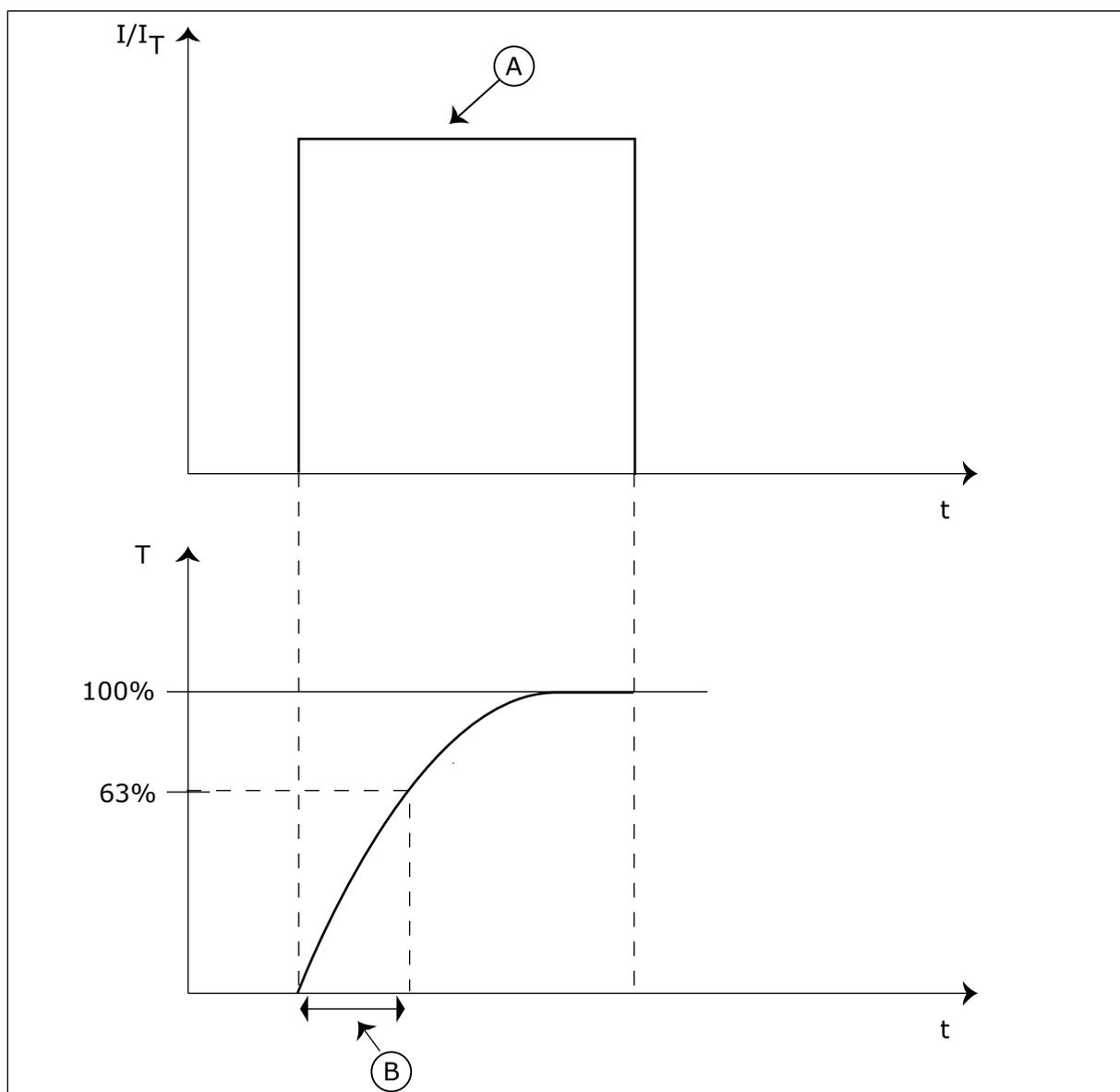
Fig. 66: Constante de temps thermique du moteur
