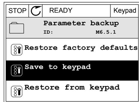
La commande Restor.par.usine rétablit les préreglages usine des paramètres. Avec la commande Enreg s/ pan opé, vous pouvez copier tous les paramètres sur le panneau opérateur. La commande Rest. de pan opé. copie tous les paramètres du panneau opérateur vers le convertisseur.
