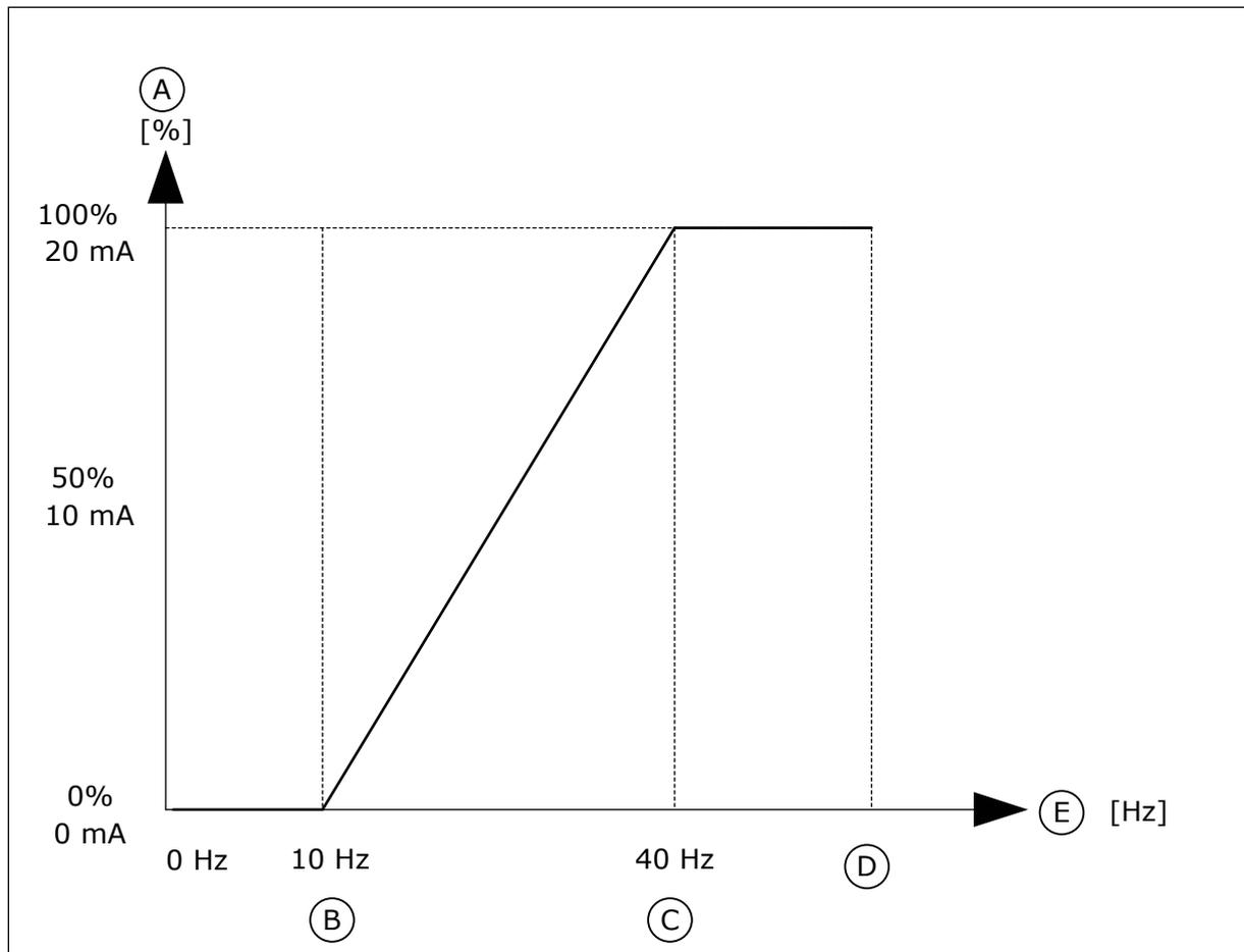
Fig. 62: Mise à l'échelle du signal A01
