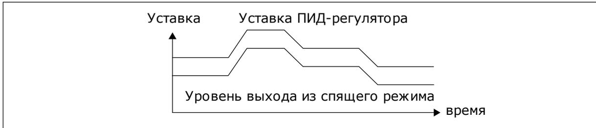
Рис. 73: Режим выхода из спящего режима: относительная уставка
