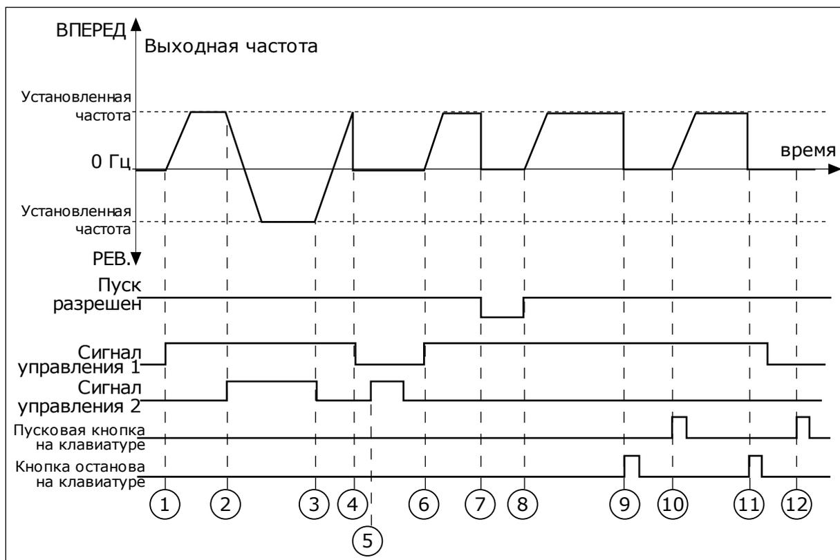
Рис. 31: Логика пуска/останова I/O A = 3
