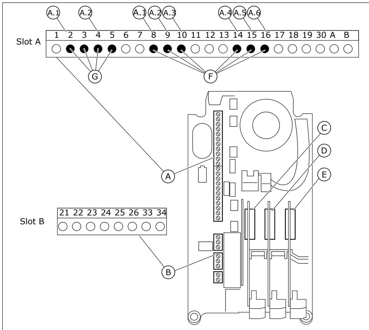
Рис. 42: Гнезда и программируемые входы дополнительных плат
