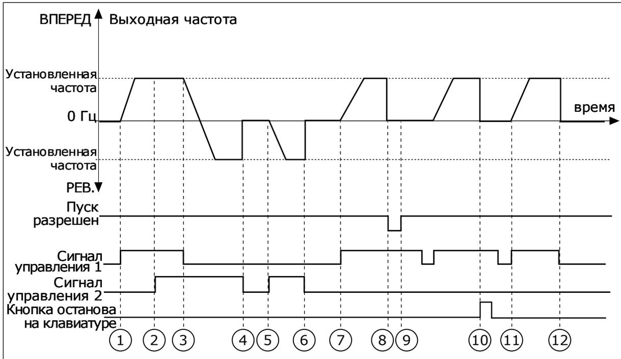
Рис. 30: Логика пуска/останова I/O A = 2
