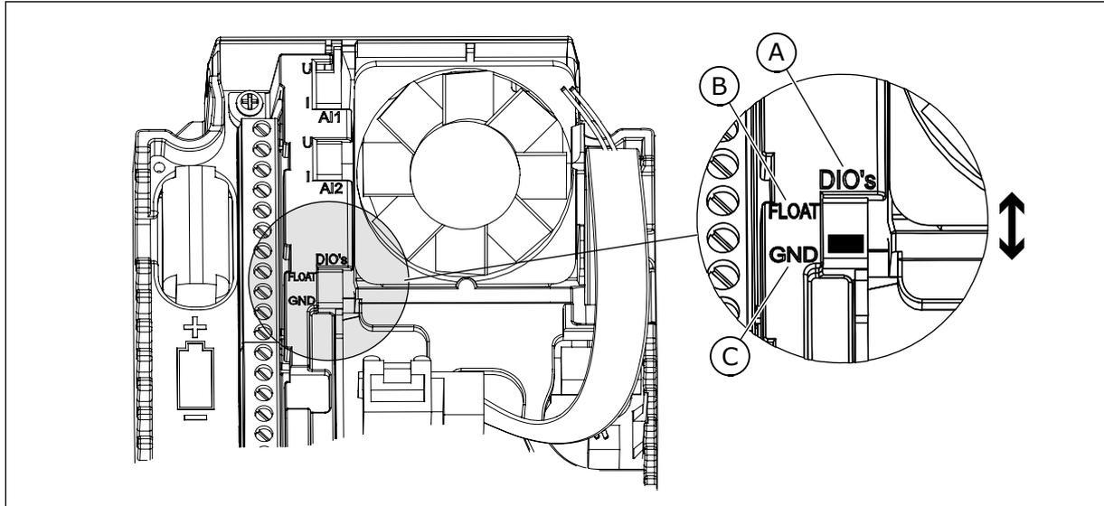
Рис. 13: DIP-переключатель
