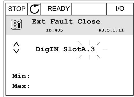
4 Нажмите кнопку со стрелкой вверх три раза, чтобы изменить значение клеммы на 6. Чтобы принять изменение, нажмите кнопку ОК.
