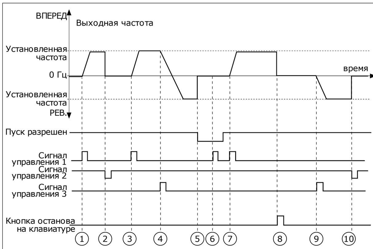
Рис. 29: Логика пуска/останова I/O A = 1
