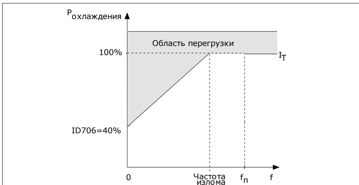
Рис. 56: Кривая теплового тока  $I_T$  двигателя
