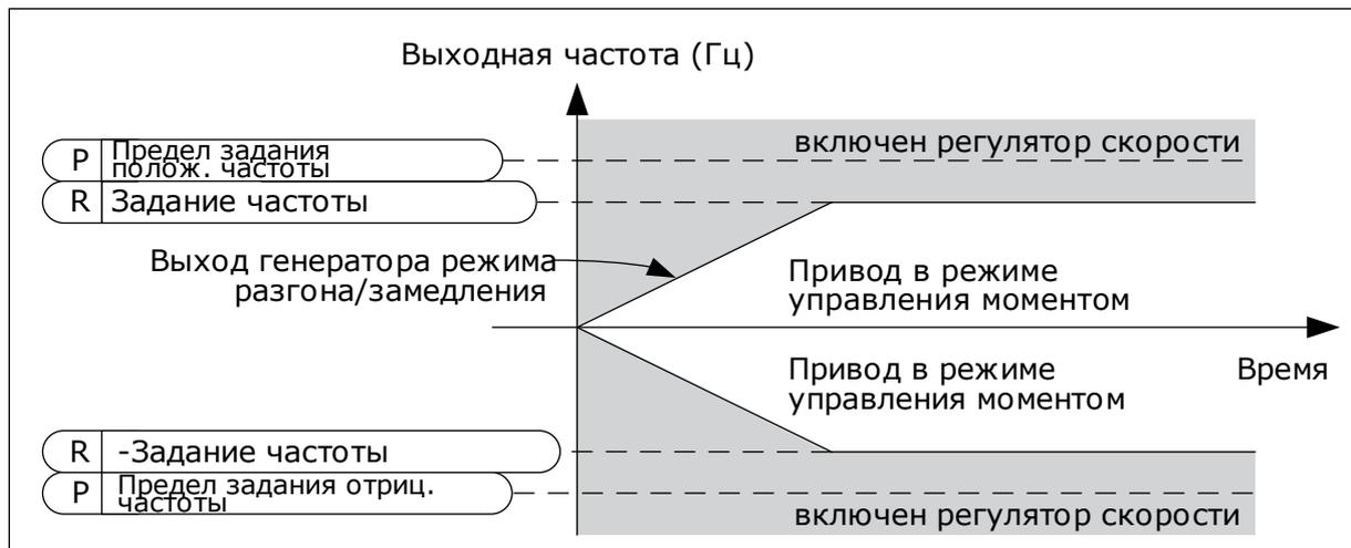
Рис. 36: Предел частоты управления моментом, выбор 1
