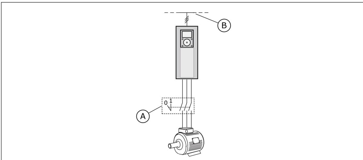
Рис. 20: Коммутатор, установленный между приводом и двигателем
