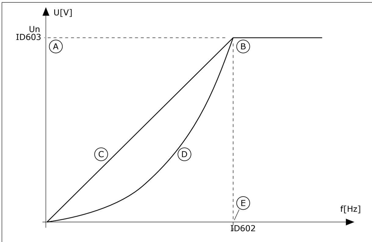
Рис. 23: Линейное и квадратичное изменение напряжения двигателя
