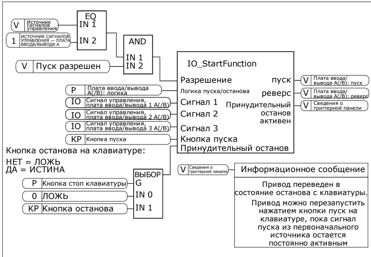
Рис. 27: Логика пуска/останова от платы ввода/вывода А, блок-схема
