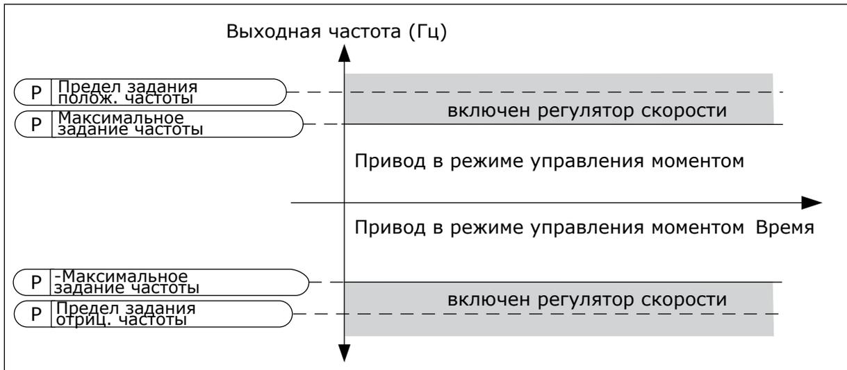
Рис. 35: Предел частоты управления моментом, выбор  $0$
