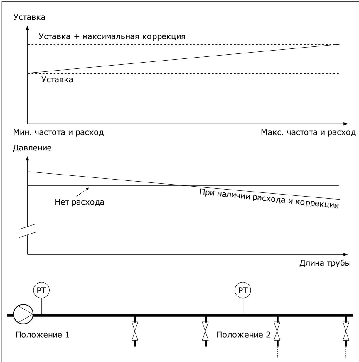
Рис. 76: Уставка 1, обеспечивающая компенсацию падения давления
