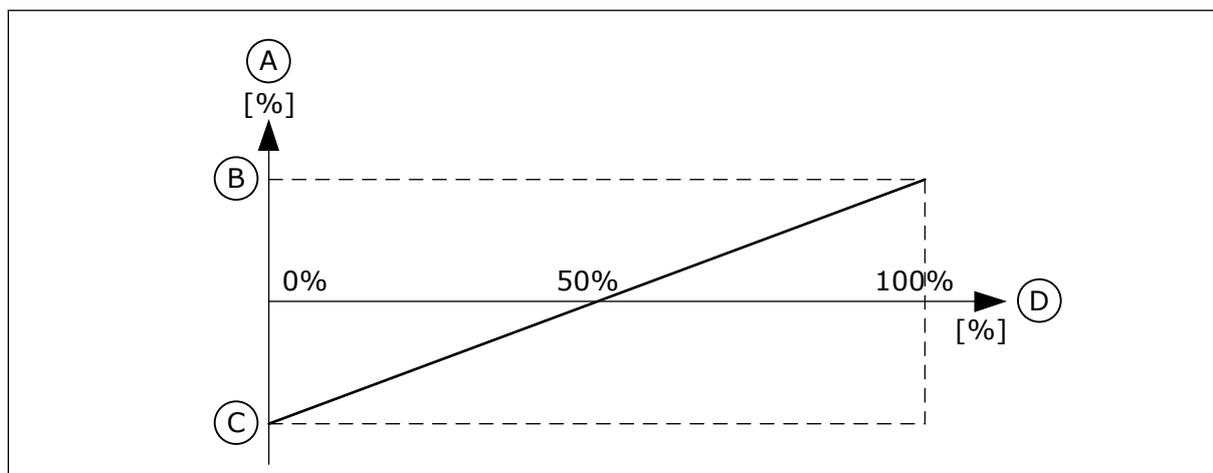
Рис. 34: Масштабирование сигнала задания момента
