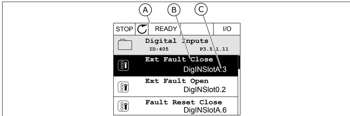
Рис. 43: Меню цифровых входов на графическом дисплее
