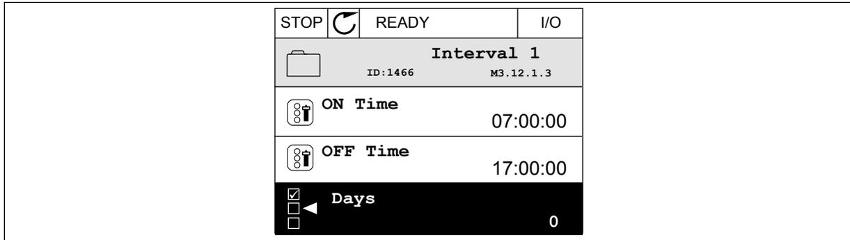
Рис. 66: Использование функций таймера для создания интервала
