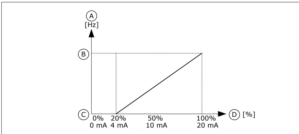
Рис. 49: Диапазон аналогового входного сигнала, вариант 1
