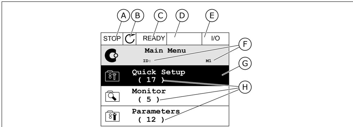
Рис. 2: Графический дисплей
