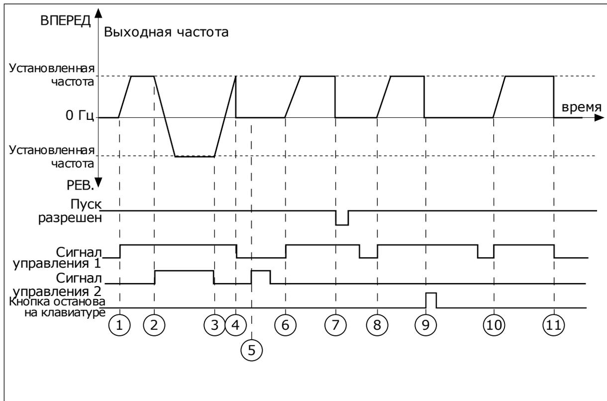
Рис. 32: Логика пуска/останова I/O A = 4
