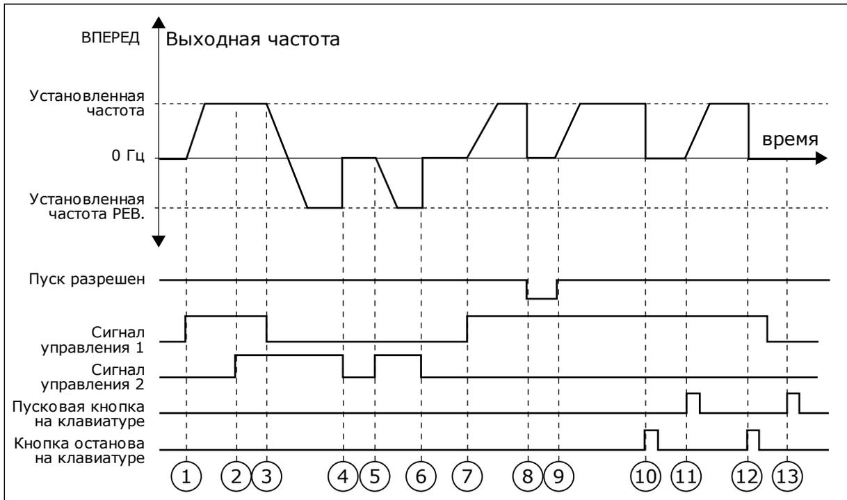
Рис. 28: Логика пуска/останова I/O A = 0
