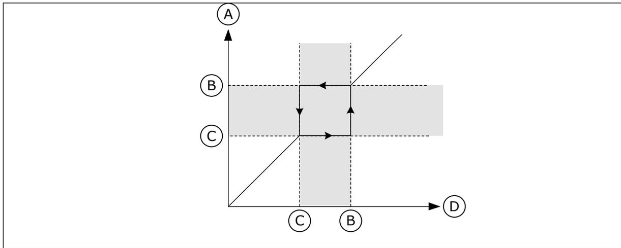
Рис. 54: Запрещенные частоты
