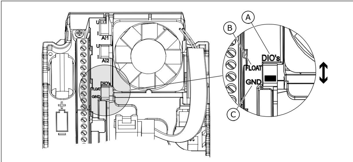
Рис. 5: DIP-переключатель
