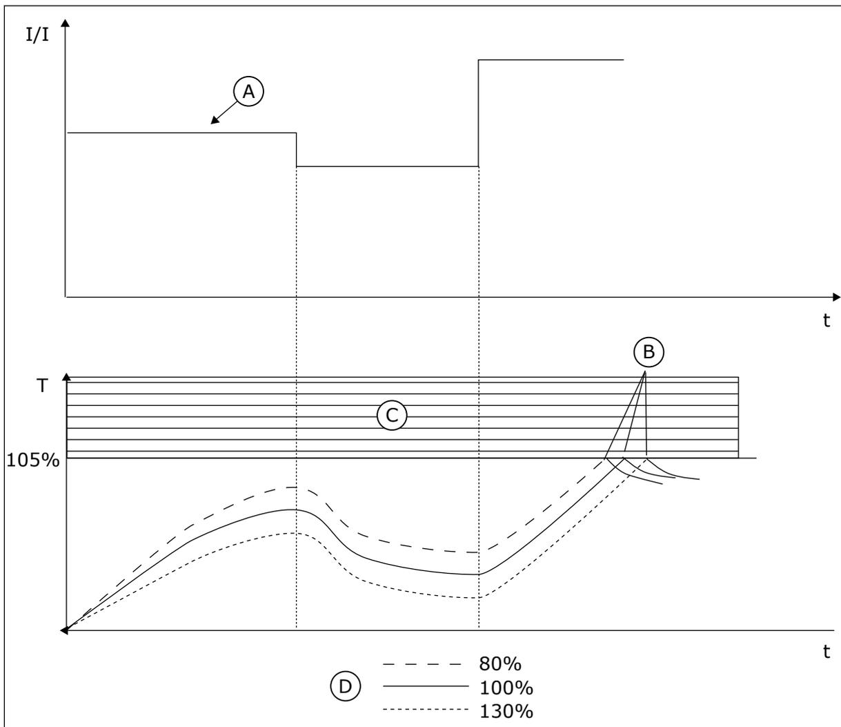
Рис. 58: Расчет температуры двигателя
