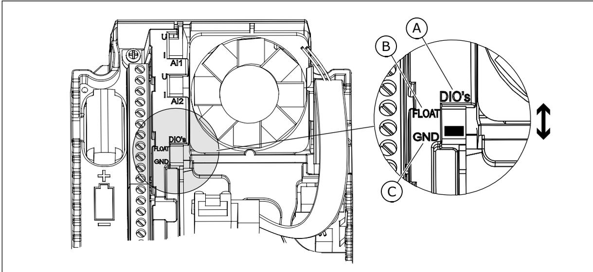
Рис. 11: DIP-переключатель
