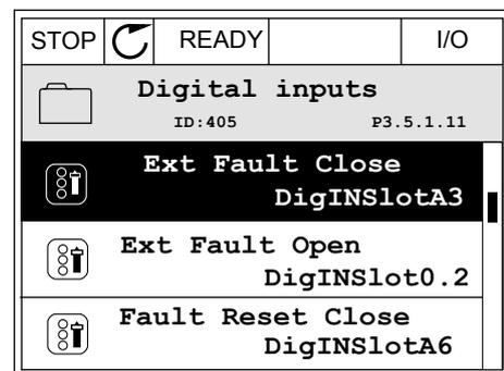
2 Вы перешли в режим редактирования, о чем свидетельствует мигающее и подчеркнутое значение гнезда ДискрВх МесПлатА. Если доступно больше цифровых входов, например на дополнительных платах, которые установлены в гнезда С, D или E, эти входы также можно выбрать.
