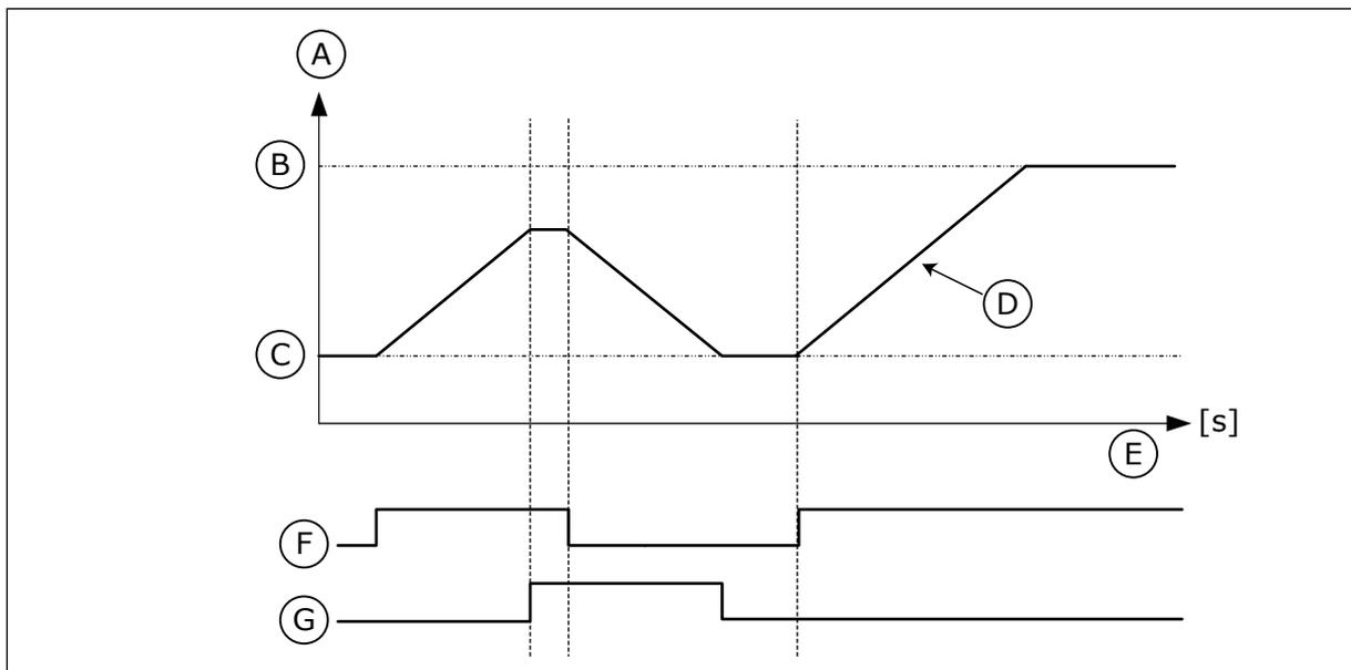
Рис. 37: Параметры потенциометра двигателя
