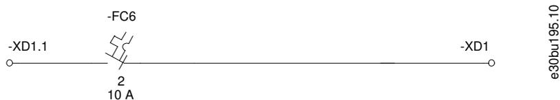
Ilustración 42: Terminales de alimentación de CA auxiliar
