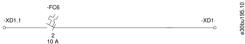
Ilustración 42: Terminales de alimentación de CA auxiliar
