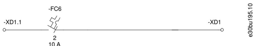
Illustration 42: Bornes d'alimentation auxiliaire CA
