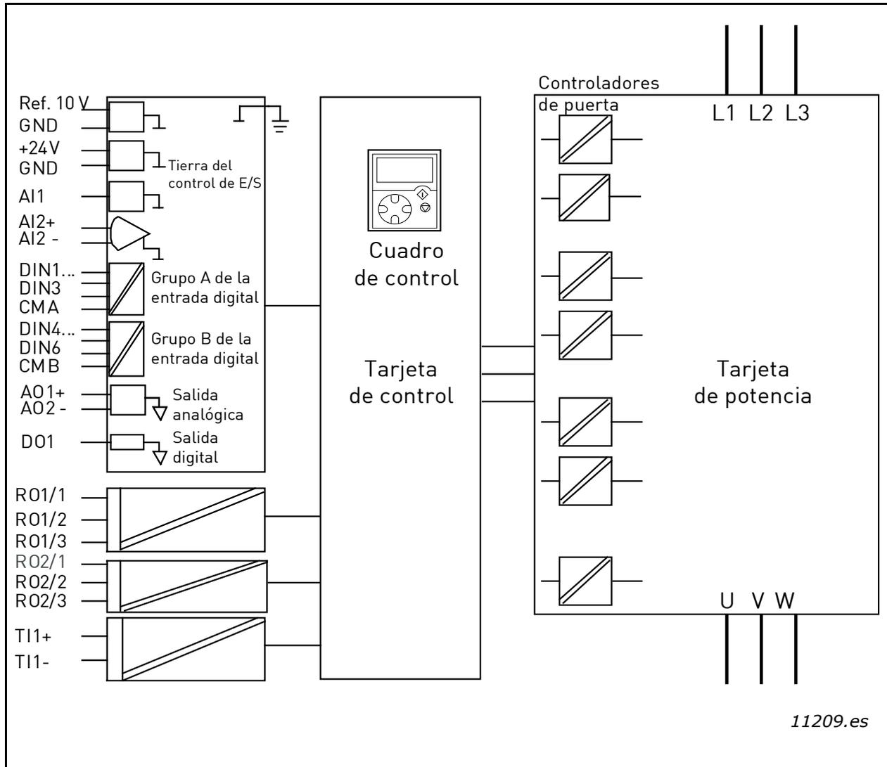
Figura 50. Barreras de aislamiento galvánico
