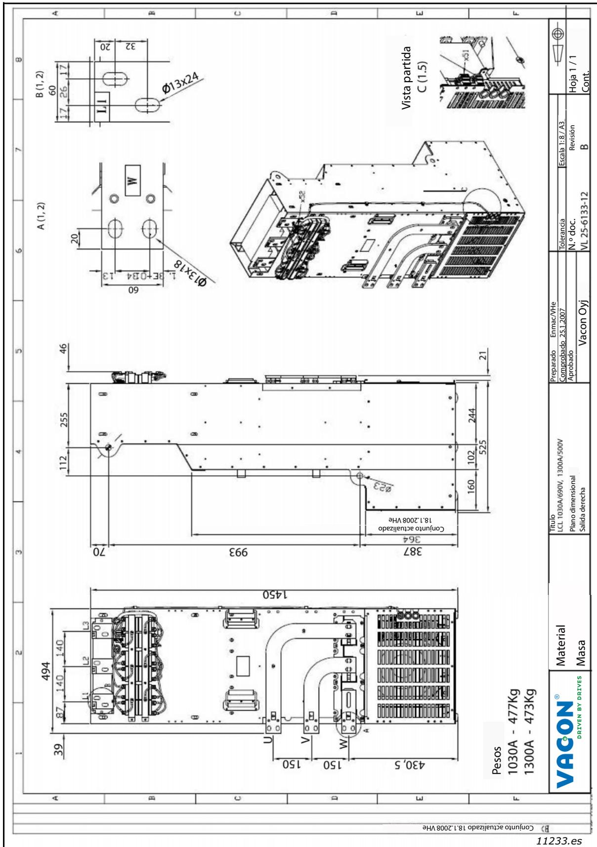
Figura 77. Dimensiones de los filtros LCL FI13, conexiones de salida a la izquierda
