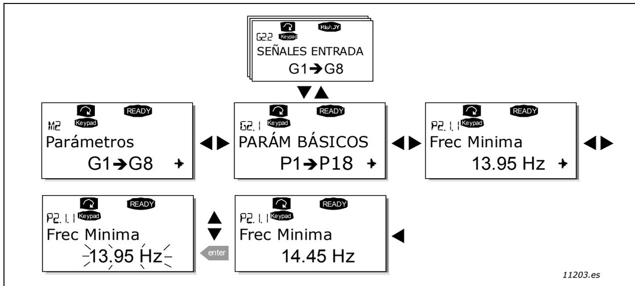
Figura 55. Procedimiento para cambiar el valor de los parámetros
