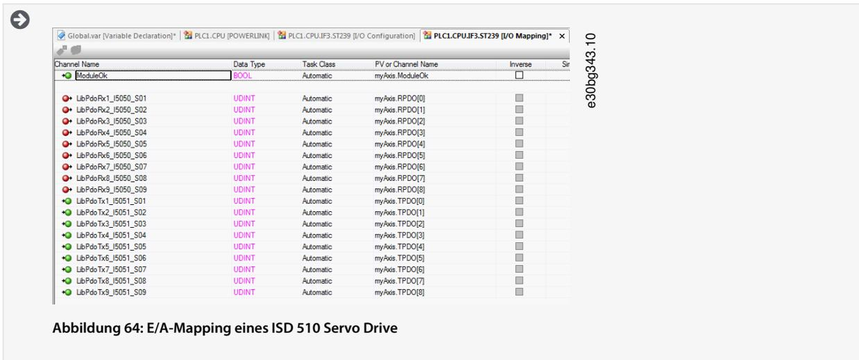
Abbildung 64: E/A-Mapping eines ISD 510 Servo Drive
