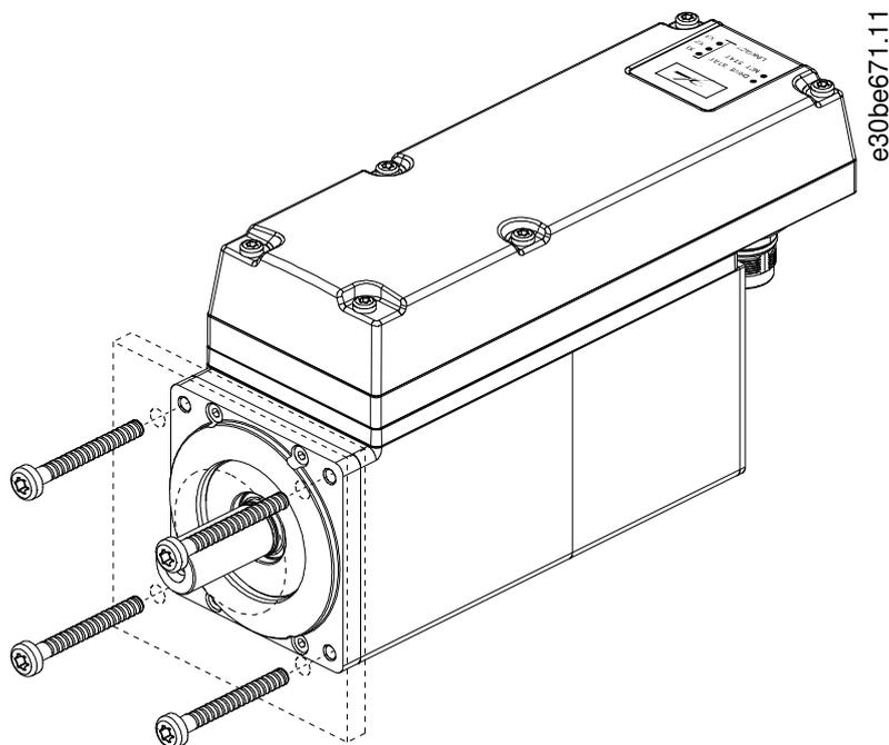
Abbildung 26: Montage eines Servoantriebs der Baugröße 2, 2,1 N ISD 510-Servoantriebe
