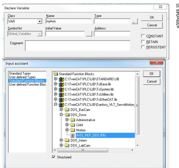
Abbildung 67: Instanziierung von *AXIS\_REF\_DDS*
