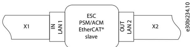
Abbildung 16: EtherCAT® Anschlusszuweisung für das Power Supply Module (PSM 510), das Auxiliary Capacitors Module (ACM 510) und die ISD 510/DSD 510-Servoantriebe
