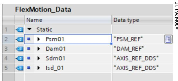
13. Überprüfen Sie im Betriebsblock *Startup [OB100]* (Anlauf [OB100]), dass die Modulzugriffspunkte korrekt zugewiesen wurden:
