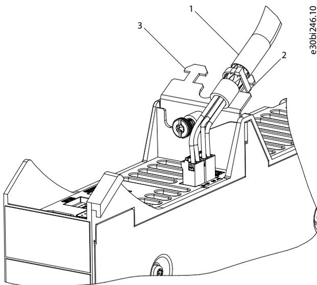
Abbildung 34: Kabelschirm an der Oberseite der Systemmodule
