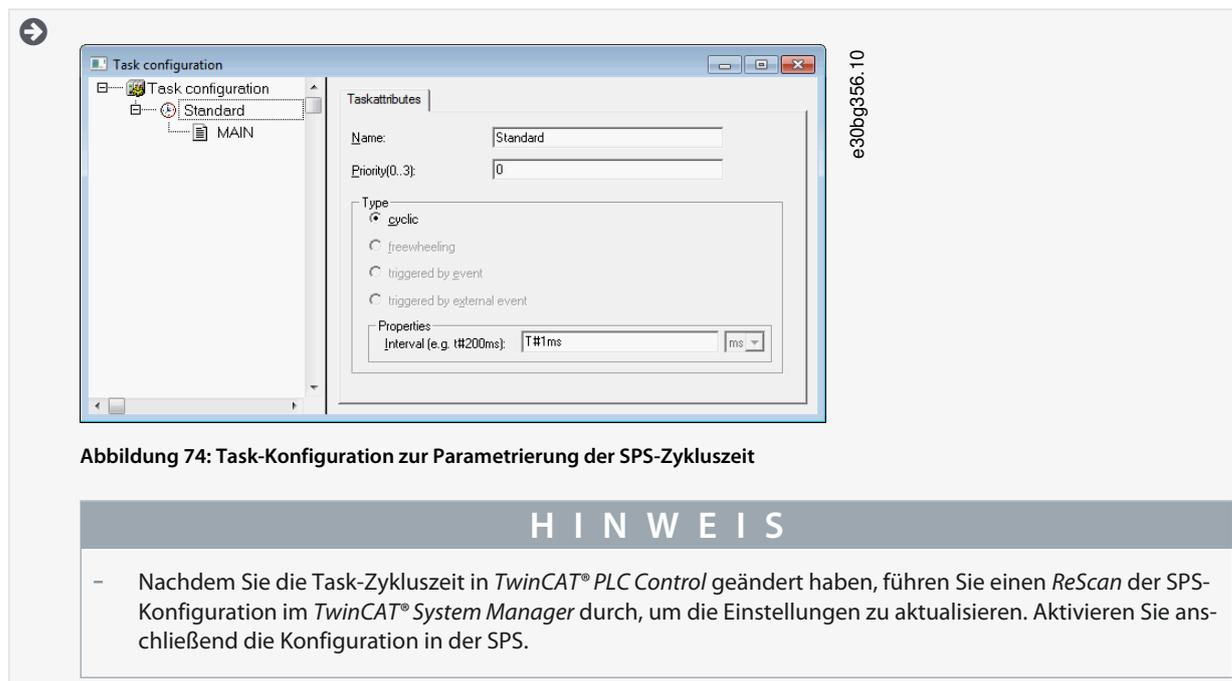
Abbildung 74: Task-Konfiguration zur Parametrierung der SPS-Zykluszeit
