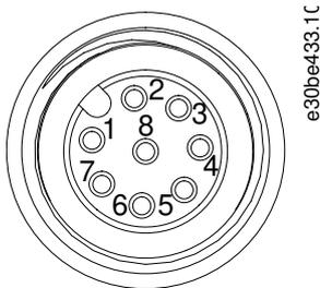
Abbildung 138: Pin-Belegung des X4 M12 E/A- und/oder Gebersteckers
