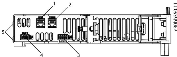
Abbildung 51: Anschlüsse an der Oberseite des ACM 510
