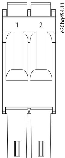
Abbildung 152: STO-Ausgangsstecker an der Oberseite des DAM 510
