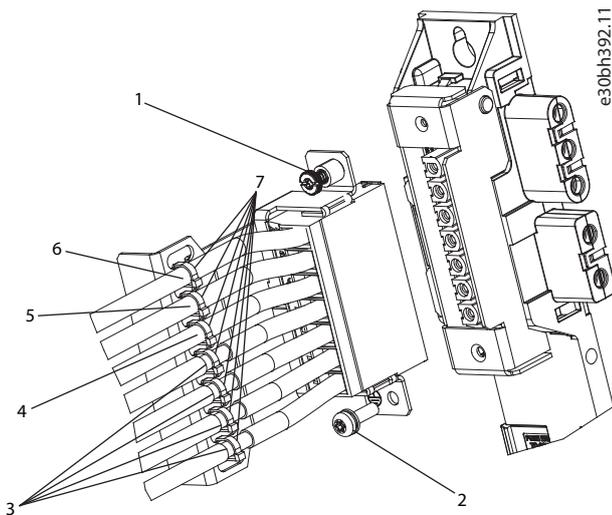
Abbildung 53: Anschließen des Expansion Module EXM 510
