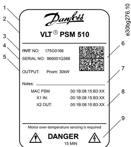
Abbildung 120: Beispiel-Typenschild an der Vorderseite der Systemmodule
