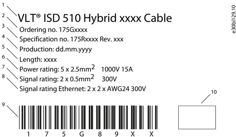
Abbildung 12: Beispiel eines Typenschilds für ein Hybridkabel
