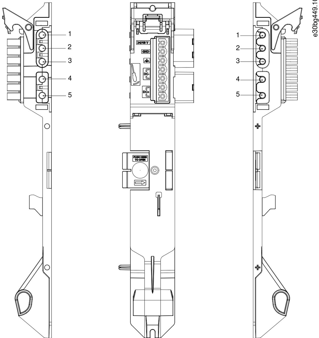
Abbildung 142: Pin-Belegung des Backlink-Anschlusses
