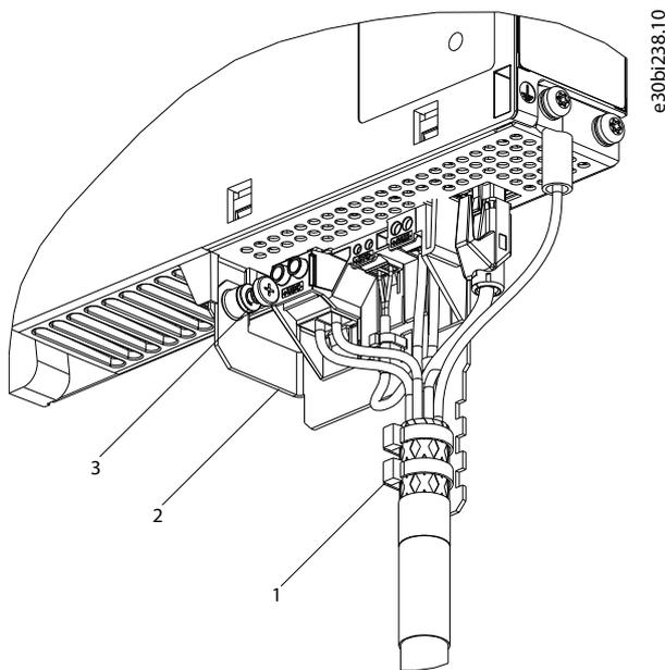
Abbildung 35: Kabelschirm an der Unterseite der Systemmodule
