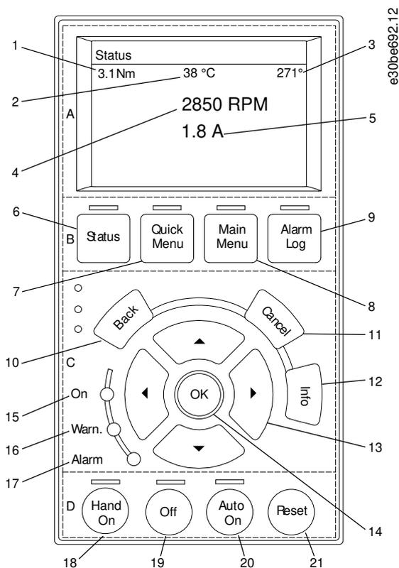
Abbildung 8: Displaybereich bei Anschluss an einen ISD 510 Servoantrieb
