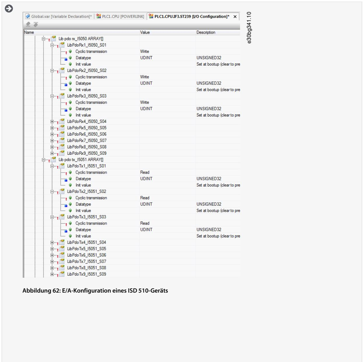
Abbildung 62: E/A-Konfiguration eines ISD 510-Geräts
