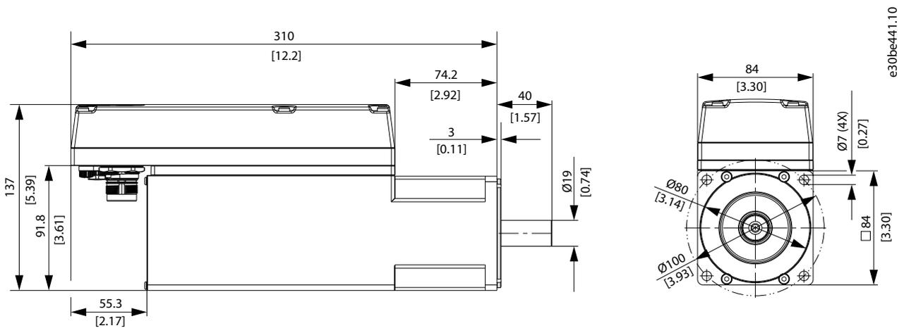
Abbildung 125: Abmessungen von ISD 510, Baugröße 2, 3,8 Nm
