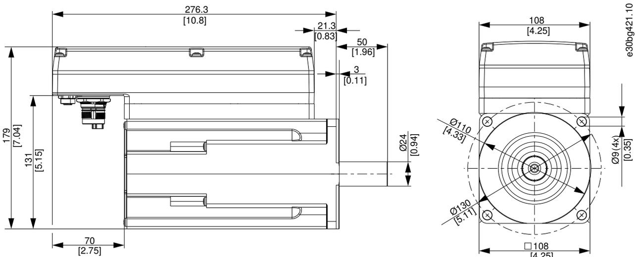
Abbildung 126: Abmessungen von ISD 510, Baugröße 3, 5,2 Nm
