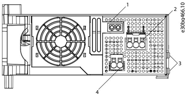
**Abbildung 46: Anschlüsse an der Unterseite des PSM 510**
