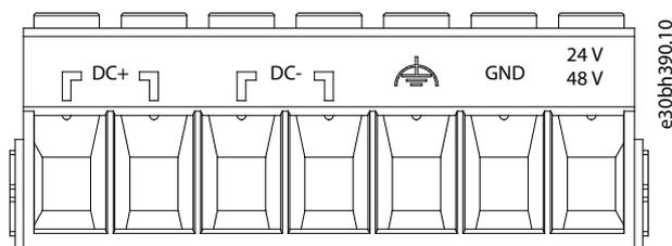
Abbildung 158: Expansion Module-Anschlussstecker
