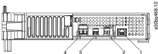
Abbildung 48: Anschlüsse an der Unterseite des DAM 510
