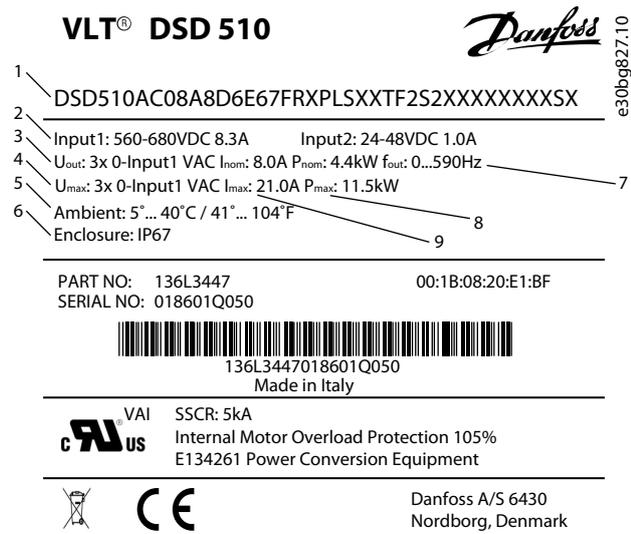
Illustrazione 119: Esempio di targa sul servozionamento DSD 510
