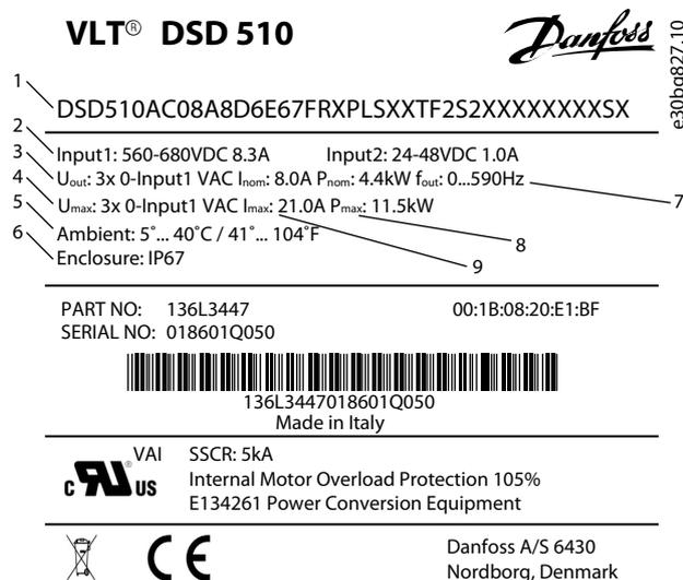
图解 119：DSD 510 伺服驱动器上的铭牌示例
