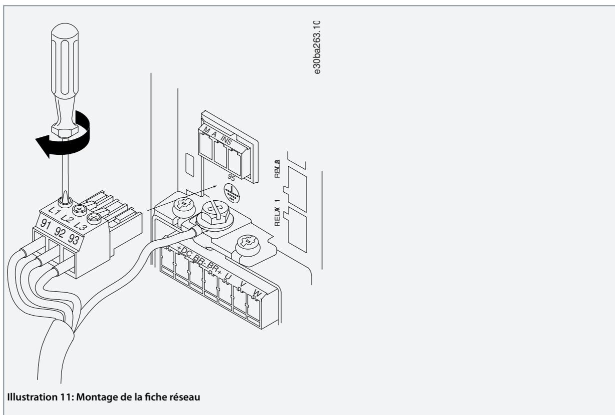
4. Monter la patte de fixation par dessus les câbles réseau et serrer les vis, comme indiqué sur l'illustration suivante. Utiliser les couples de serrage décrits au point [3.2.1 Installation électrique – généralités](#).
