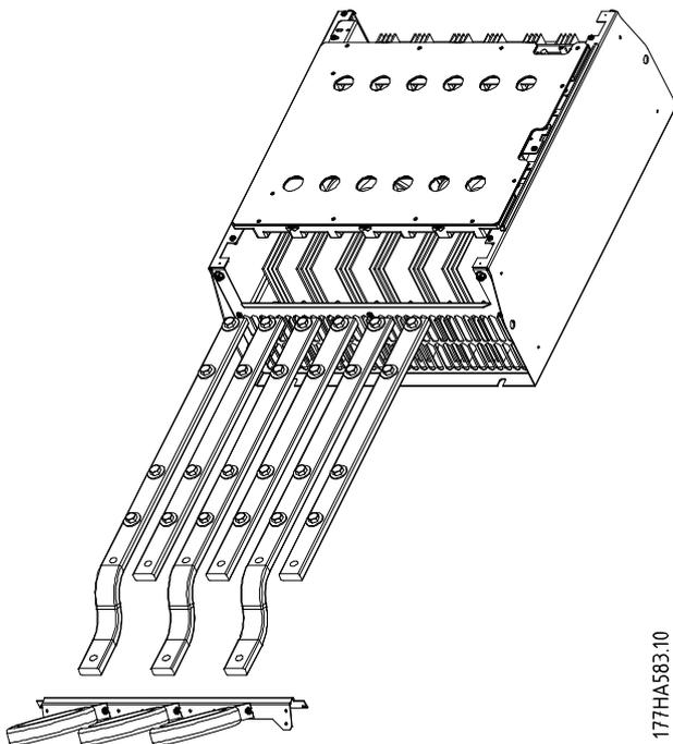
Abbildung 12.2 Sammelschienen
