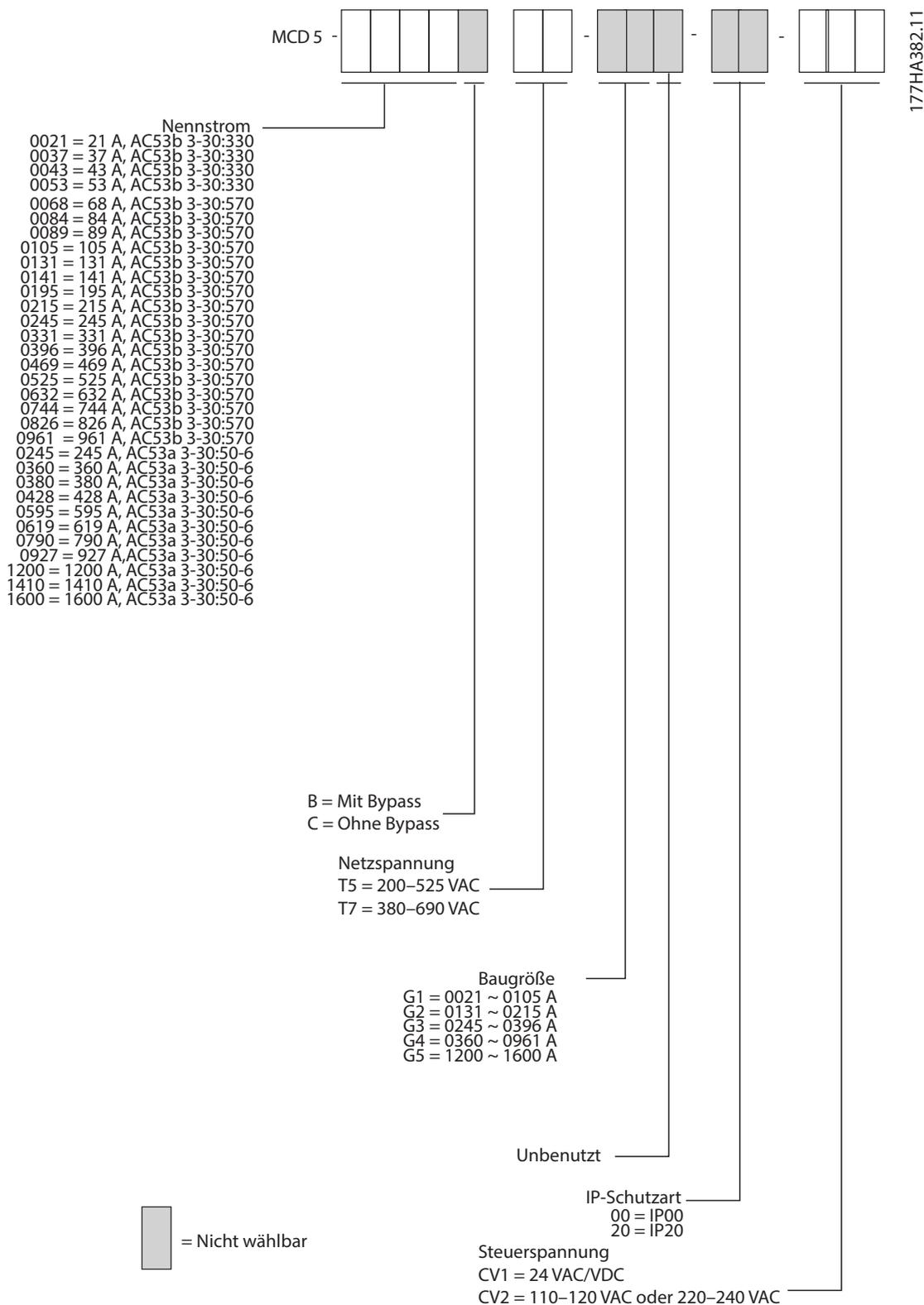
Abbildung 1.1 Bestellformular Typencode
