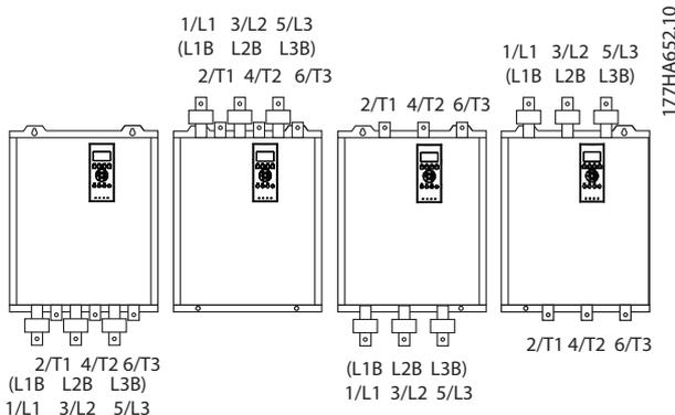
Abbildung 4.8 Position der Bypass-Klemmen, MCD5-0360C bis MCD5-1600C, 360–1600 A
