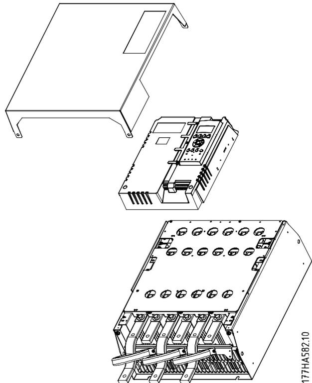
Abbildung 12.1 Entfernen der Frontabdeckung und des LCP
