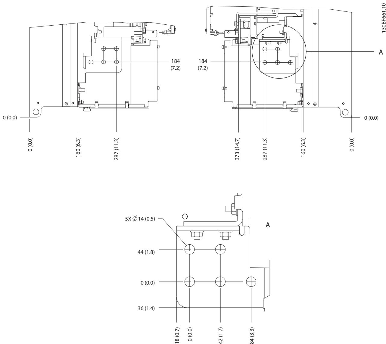
Disegno 5.11 Dimensioni dei morsetti di rete, motore e terra E3h (viste laterali)
