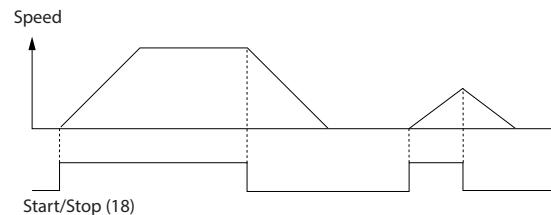
그림 7.2 Safe Torque Off 옵션이 있는 기동/정지 명령
