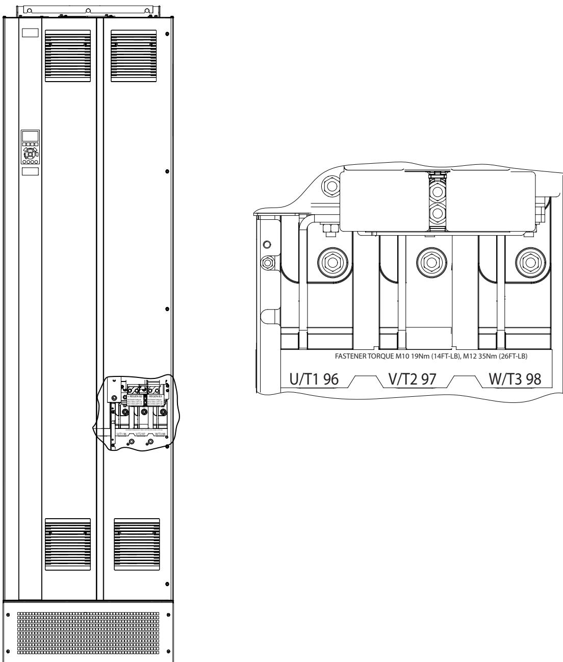
그림 5.3 AC 모터 단자(예시 E1h). 자세한 단자 보기는 장을 5.7 단자 치수율(률) 참조하십시오.
