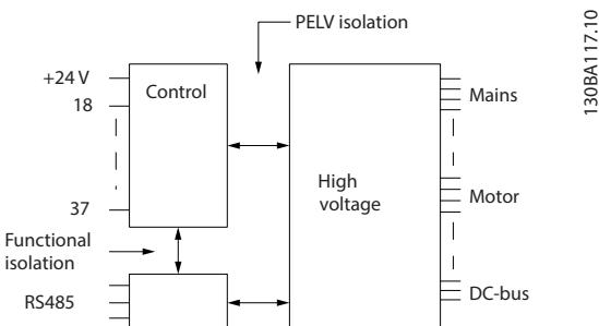
**Illustration 10.1 PELV Isolation****Pulse inputs**
