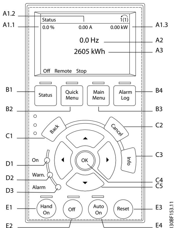
圖 3.4 圖形化 LCP 操作控制器
