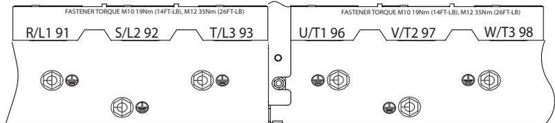
圖 5.5 接地端子 (所示為 E1h)。詳細的端子視圖，請參考 章 5.7 端子尺寸
