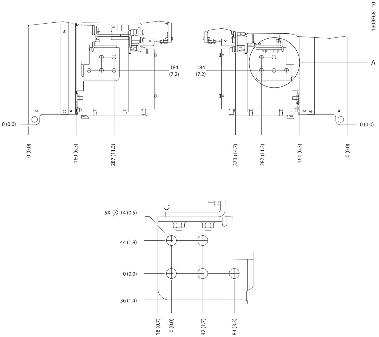
圖 5.14 E4h 主電源、馬達與接地端子尺寸 (側面視圖)
