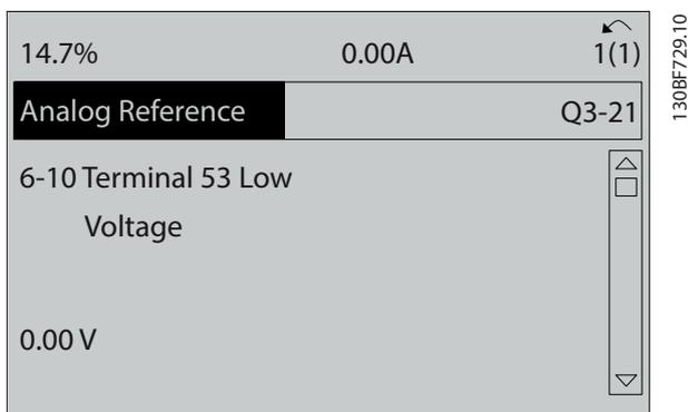
圖 6.8 參數 6-10 端子 53 最低電壓
