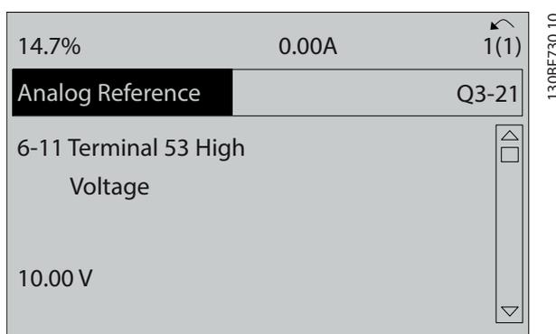
圖 6.9 參數 6-11 端子 53 最高電壓
