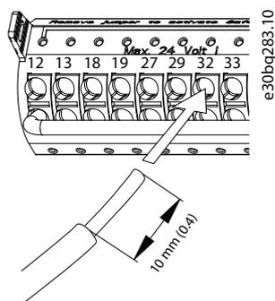
圖 5.19 連接實心的控制電線
