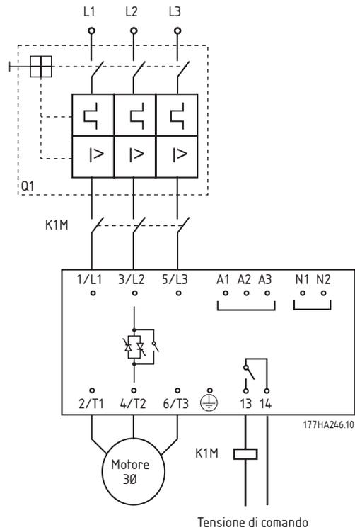
Esempio 3 - MCD 201 installato con interruttore, contattore di sovraccarico e di rete.
