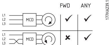
L'MCD 202 è una rotazione di fase insensibile. Questa funzione consente alla rotazione del motore di muoversi in una sola direzione. Impostare la protezione secondo i requisiti di applicazione.
