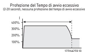
Questo fornisce la prima indicazione che le condizioni di applicazione sono cambiate o che il motore si è fermato. Può anche evitare che l'avviatore sia messo in funzione oltre i limiti della sua capacità d'avviamento nominale.
