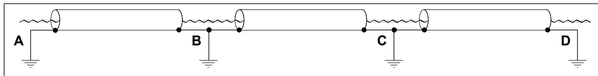
Bild 41: Jordning i störande miljö med bra utjämningspotential. Om potentialerna vid punkterna A, B, C och D är olika och inte kan göras likadana, ska skärmarna kapas som i Bild 42.
