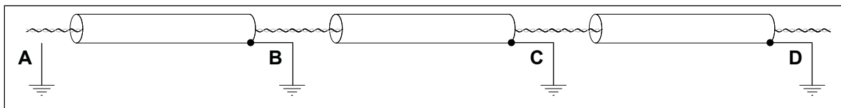
Bild 39: Jordning i störande miljö med dålig utjämningspotential. Ett exempel på hur skärmen kapas.
