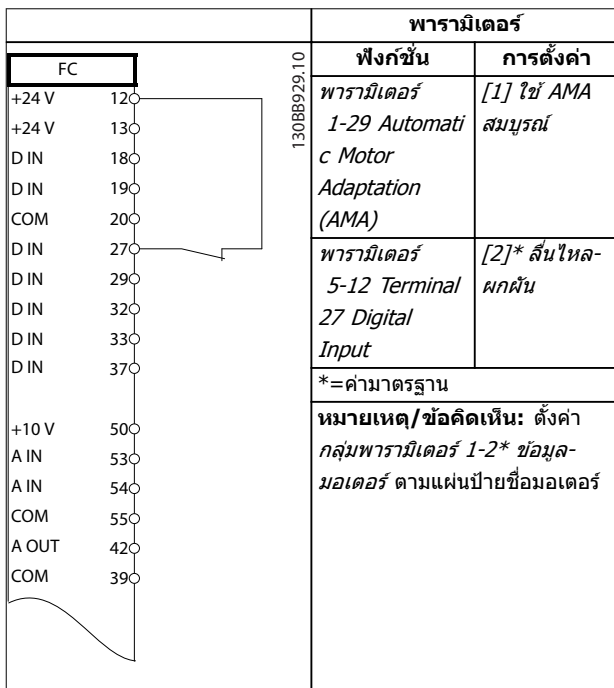
ตาราง 8.1 รูปแบบการเดินสายสำหรับ AMA ที่มี T27 เชื่อมต่ออยู่
