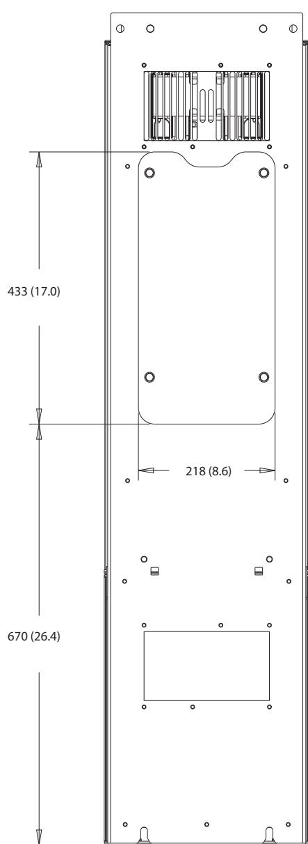
图 8.28 D5h 的散热片气流罩板尺寸
