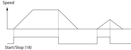
图 12.2 带 Safe Torque Off 的启动/停止
