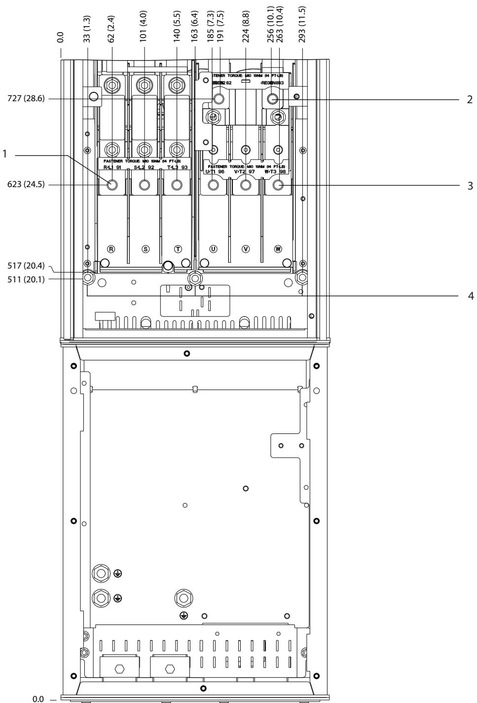
图 8.33 带制动器选件的 D5h 端子尺寸 (正视图)
