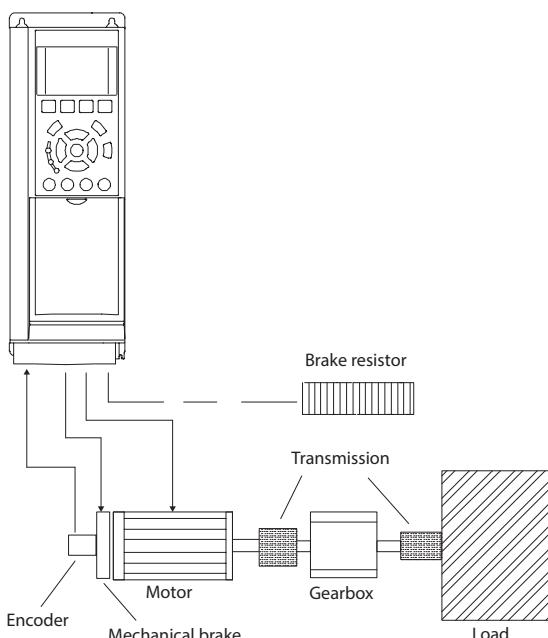
图 12.1 FC 302 闭环速度控制的基本设置
