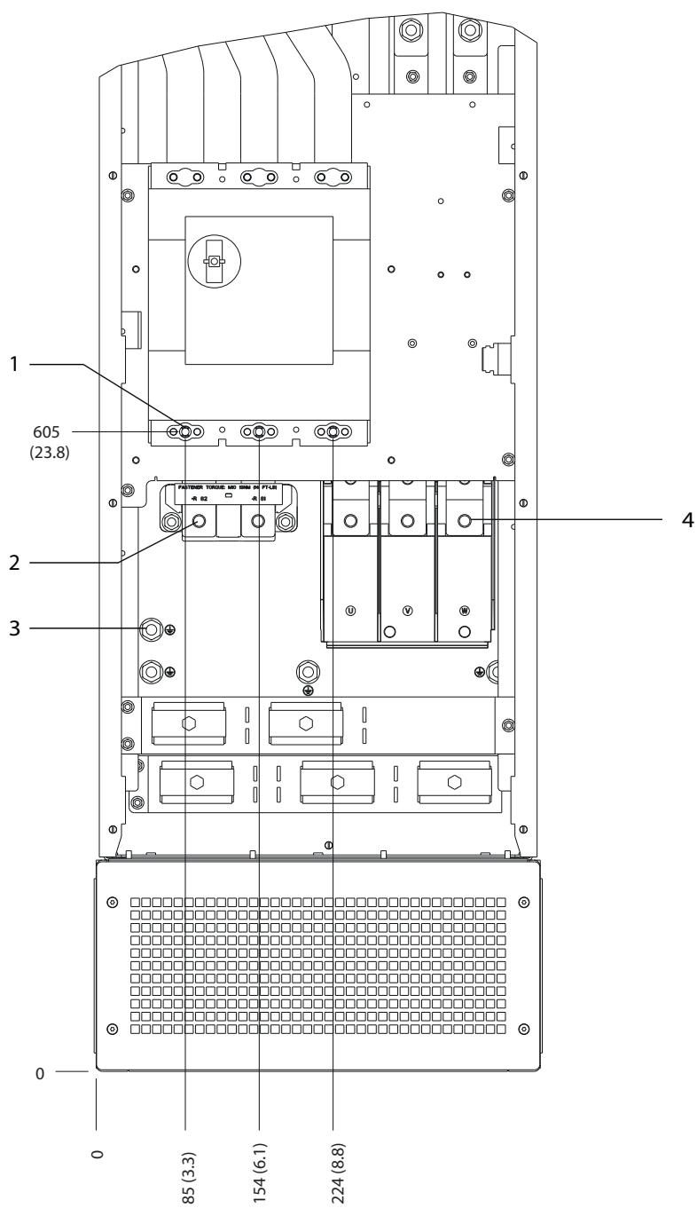
图 8.68 带断路器选件的 D8h 端子尺寸 (正视图)
