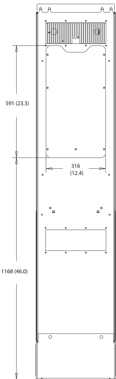
图 8.50 D7h 的散热片气流罩尺寸
