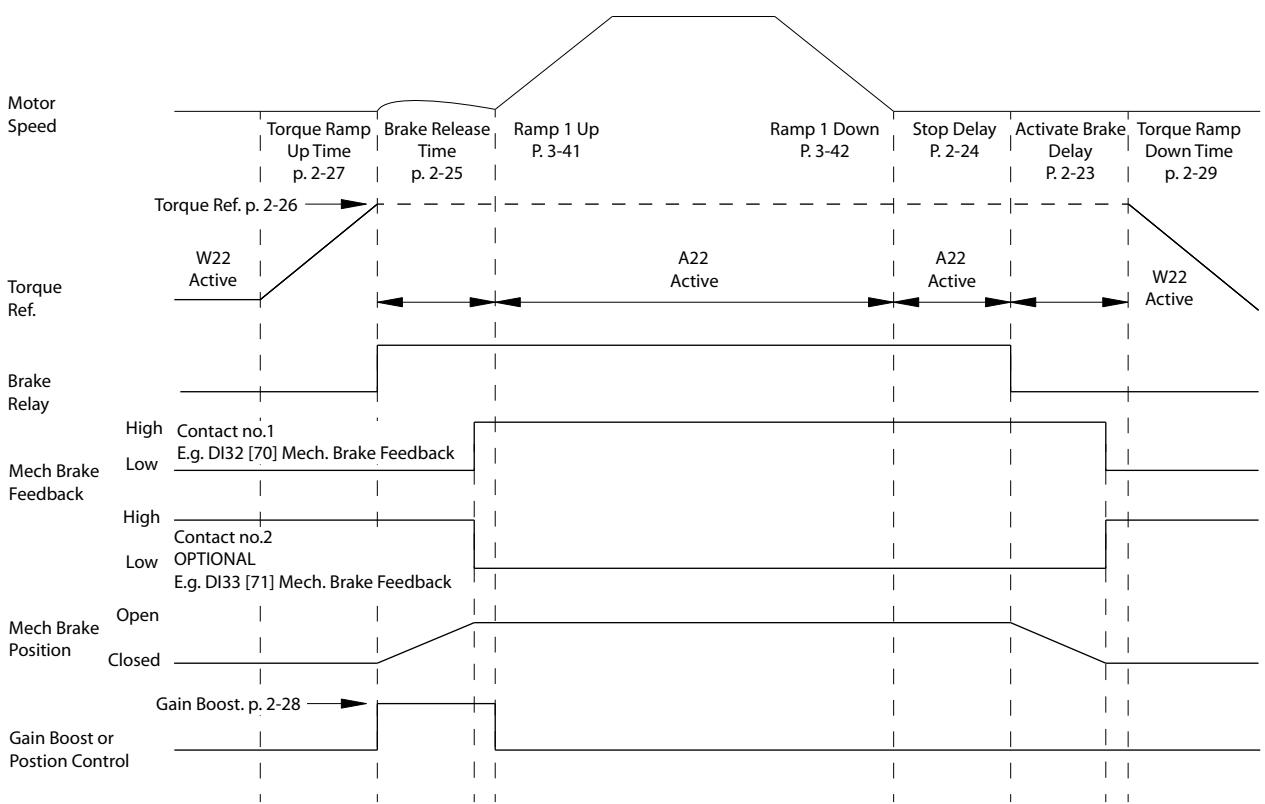
图 5.8 起重机械制动控制的抱闸释放过程
