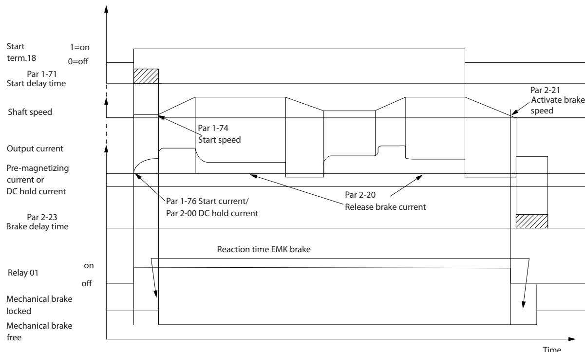
图 5.7 开环中的机械制动控制
