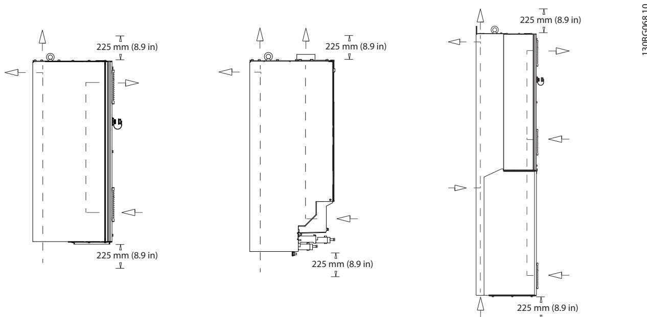
图 5.10 机箱 D1h/D2h (左)、D3h/D4h (中) 和 D5h - D8h (右) 的标准气流配置。
