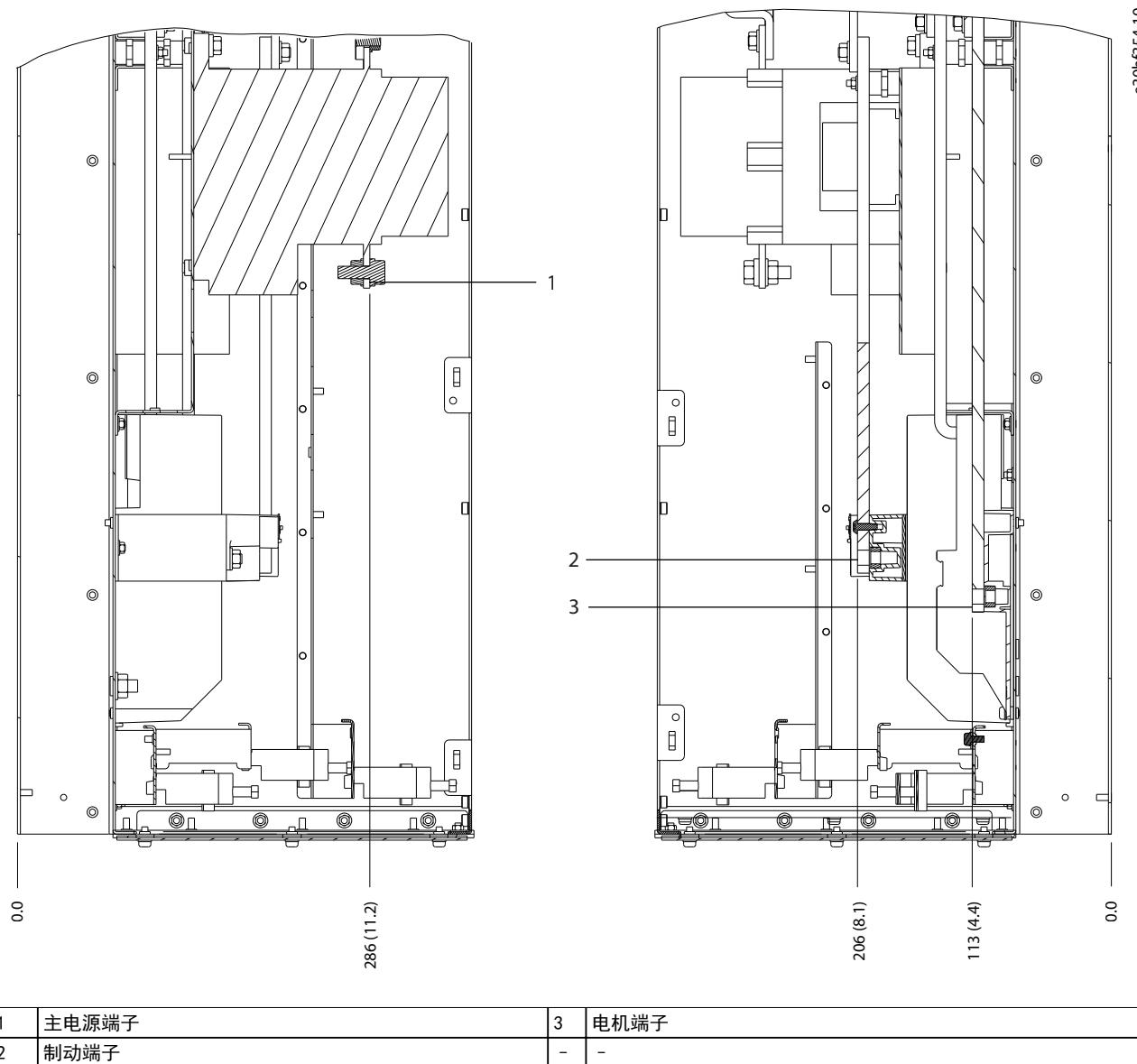
图 8.42 带接触器选件的 D6h 端子尺寸 (侧视图)
