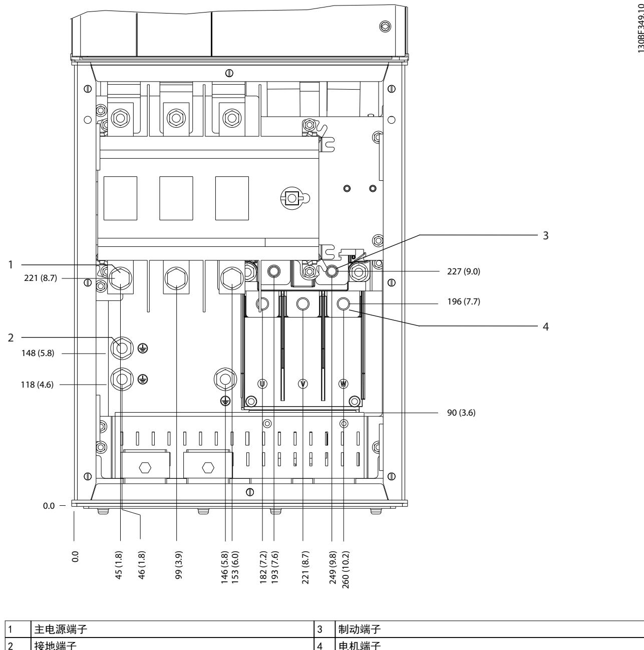
图 8.31 带隔离开关选件的 D5h 端子尺寸 (正视图)
