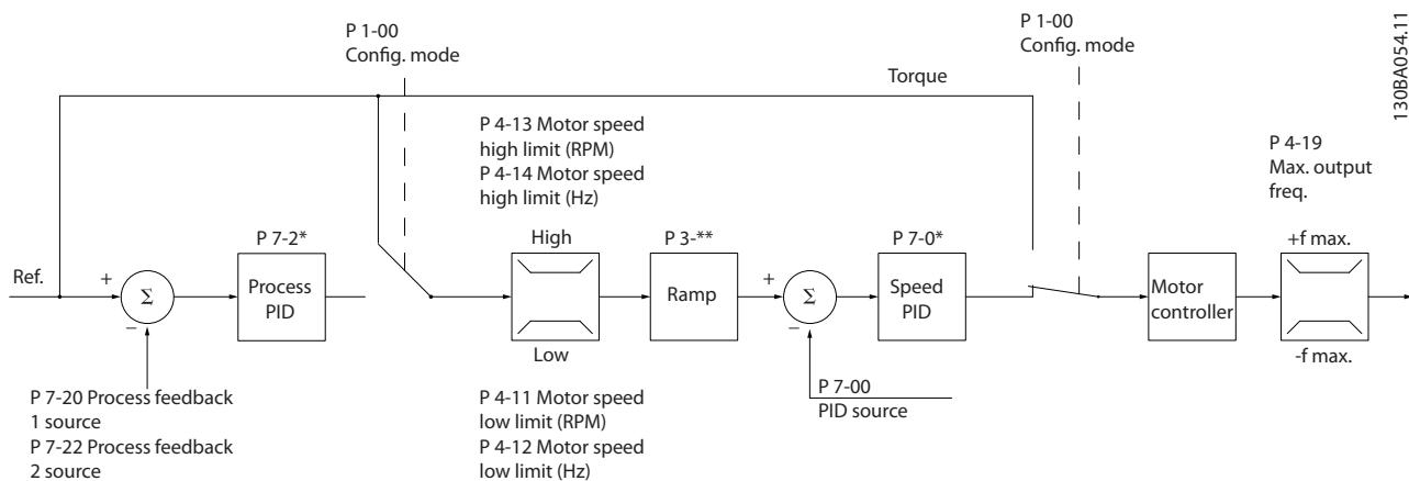
图 11.10 磁通矢量带反馈配置下的控制结构
