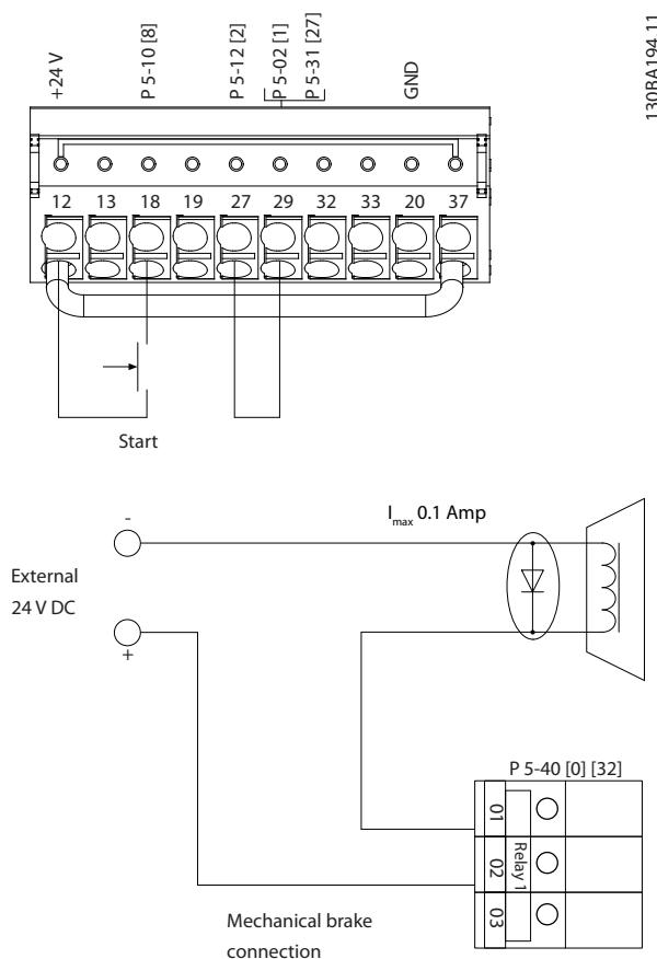
图 12.8 用于转矩和停止极限的接线配置
