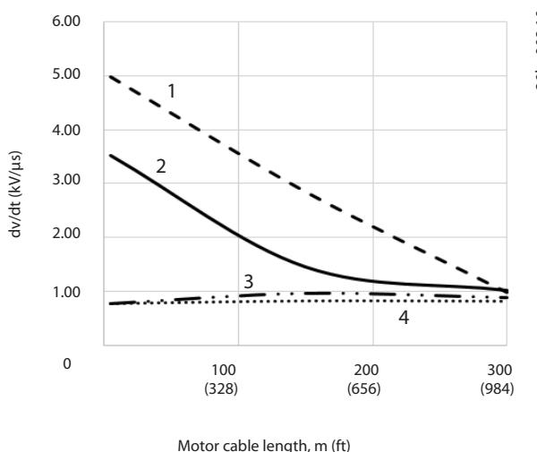
图 10.21 E2h/E4h 机箱的电机端子处的  $dU/dt$ , 525 - 690 V
