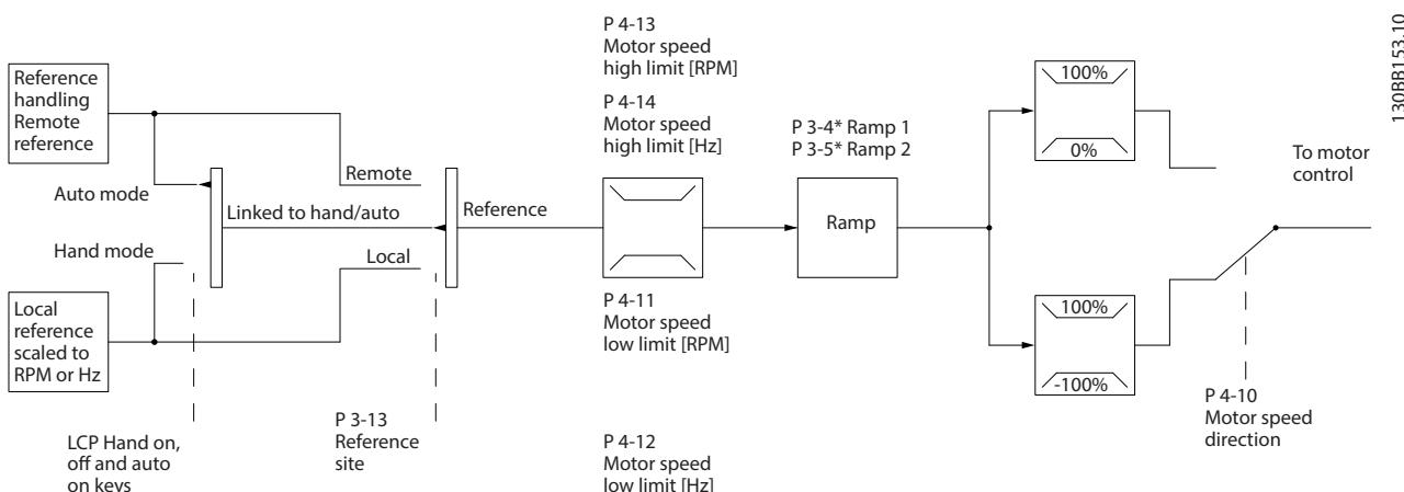
图 11.6 开环控制结构的框图
