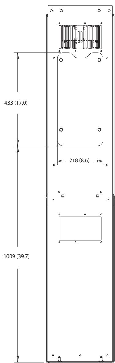
图 8.38 D6h 的散热片气流罩板尺寸
