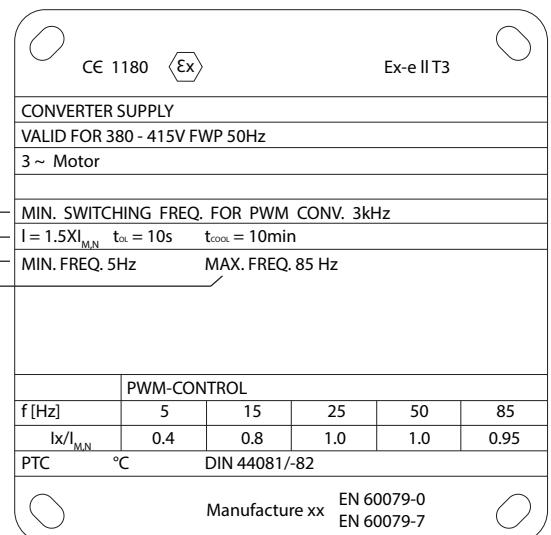
图 5.2 显示出变频器要求的电机铭牌
