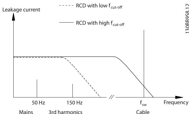
图 10.14 漏电电流的主要成分
