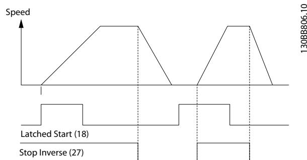
图 12.3 自锁启动/停止反逻辑
