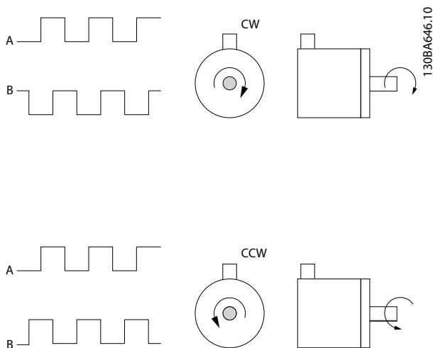
图 12.6 确定编码器方向
