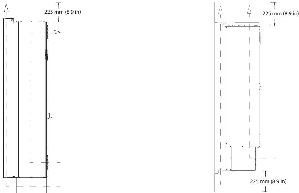
图 5.12 E1h/E2h (左) 和 E3h/E4h (右) 的标准气流配置
