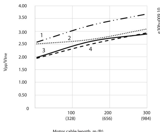
图 10.22 E2h/E4h 机箱的电机端子处的峰值电压, 525 - 690 V
