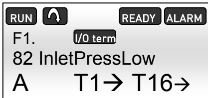
图 5.1-4, 在 NXP 面板上的低压报警
