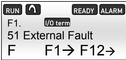
图5.1-5, 在 NXP 面板上的泄漏报警
