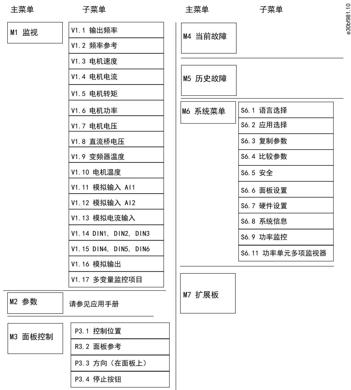
图解 5：交流变频器的基本菜单结构
