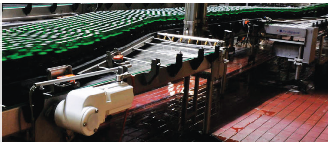
Se muestra el VLT® FlexConcept en la línea de llenado, junto con el VLT® OneGearDrive®.
