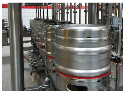
La modernización de la planta también ha aumentado la capacidad de llenado de 120 barriles por hora a 280, aproximadamente. La línea de llenado está totalmente automatizada: la única tarea que exige un esfuerzo manual es el suministro de pilas de palés con 6 barriles por palé en el mecanismo de carga, para lo cual se necesita un apilador
