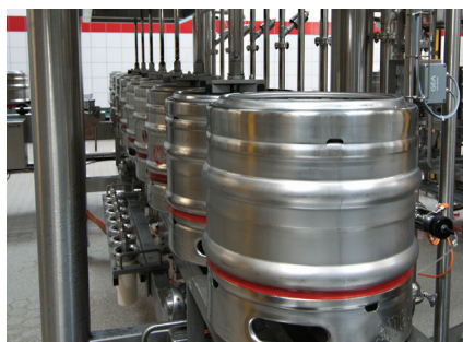
Modernizací závodu došlo i ke zvýšení kapacity stáčení ze 120 KEG sudů za hodinu na až 280. Plnicí linka je plně automatizovaná; jediný manuálně prováděný úkon spočívá v podávání štosů palet po šesti sudech na vstup pomocí stohovače.
