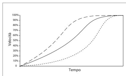
Tre profili iniziali di controllo adattativo dell'accelerazione (AAC); accelerazione anticipata, accelerazione costante, accelerazione ritardata
