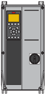
A4 IP55 mit Netztrennschalter
