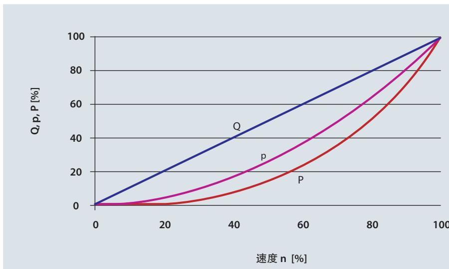
流体设备的比例法则。由于物理关系，吞吐量  $Q$ 、压力  $p$  和功率  $P$  直接取决于带有流体设备的设备速度。
