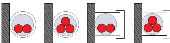
安装方式 B2：线管或封闭式配电槽中的多芯电缆或多心屏蔽电缆
