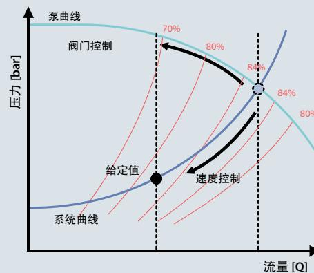
除泵和系统特性曲线外，此图还显示了一些效率水平。阀门控制和速度控制均会导致工作点移出最佳效率范围。
