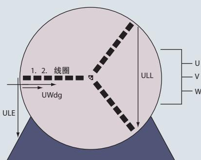
脉冲电压会出现在电机的电机端子上 ( $ULE$ ) 和线圈和叠片组之间 ( $U_{wdg}$ )。线圈 ( $U_{wdg}$ ) 之间还存在电压应力。
