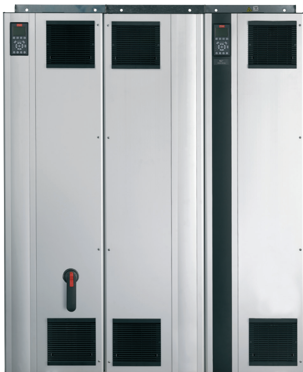
Przetwornica częstotliwości z redukcją harmonicznych (ang. Low harmonic drive) składa się ze standardowej przetwornicy z wbudowanym filtrem aktywnym oddziałującym na sieć zasilającą.
