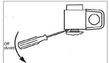
Retirez la bobine clip-on à l'aide d'un tournevis.
