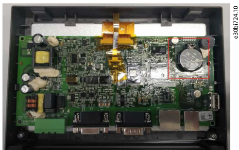
Ілюстрація 75: Розташування акумулятора всередині ЛМІ
