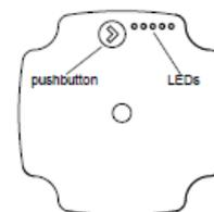
Abb. 1. Bedienfeld mit einer Drucktaste und fünf LED's
