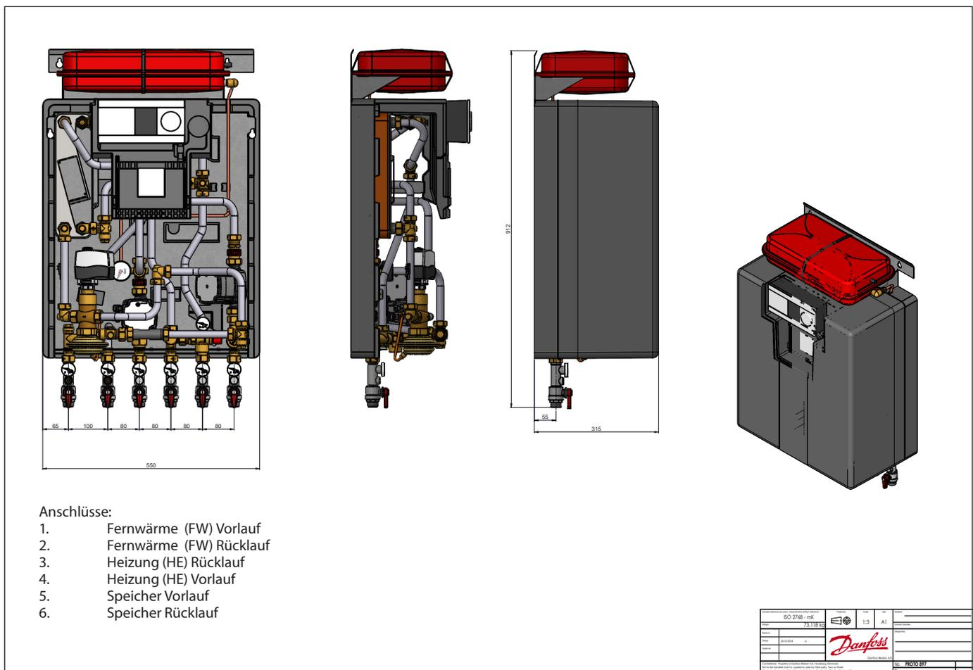
5. HYDRAULIKSCHEMA, ABMESSUNGEN, BEISPIEL - VXE SOLO HWS 310/A347
