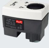
Knopf auf der Unterseite des Stellantriebes gedrückt halten während der Antrieb zur manuellen Hubverstellung gedreht wird.
