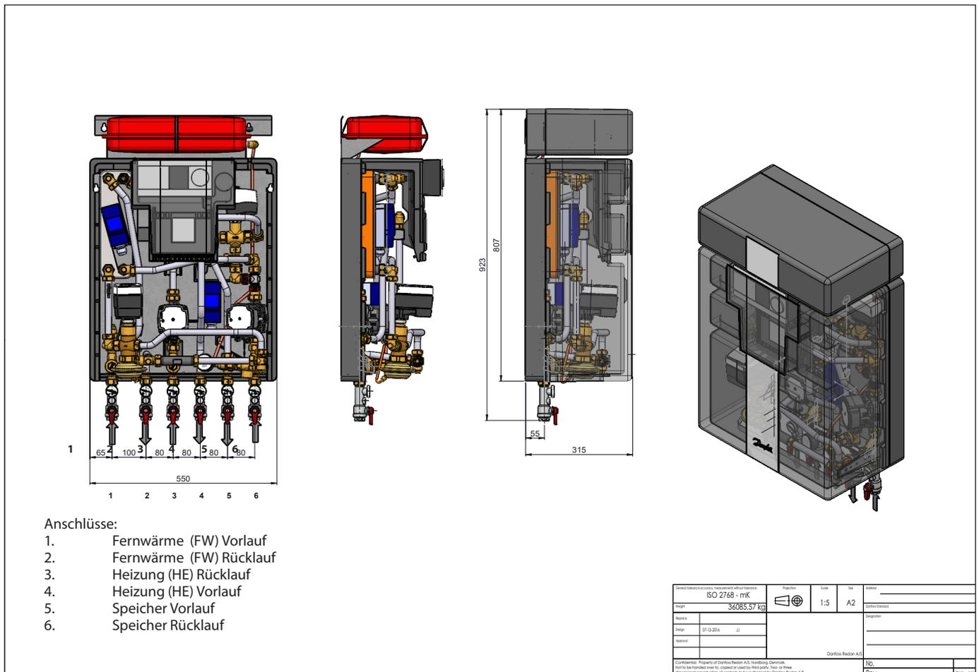
5. HYDRAULIKSCHEMA, ABMESSUNGEN - VXE SOLO H OP ECL 310
