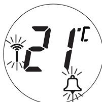
Ikone za mrežnu vezu i alarm svijetle, što znači da je *living connect®* spreman za povezivanje s uređajem Danfoss Link™ CC.
