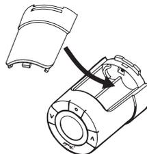
Posizionare nuovamente il copribatteria. Installare *living connect*® su un altro adattatore di valvola secondo le istruzioni fornite con l'adattatore.
