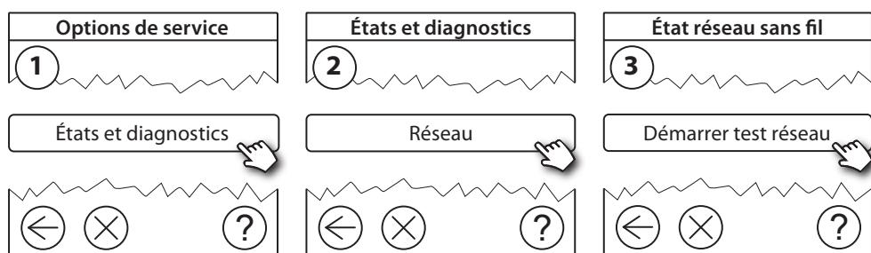
À la fin du test de réseau, le Danfoss Link™ CC attend que les unités alimentées par piles s'activent et envoient un signal. Veuillez suivre les instructions indiquées à l'écran. Si le test du réseau s'effectue correctement, il n'est pas nécessaire d'intervenir. Si le test du réseau s'effectue lentement, le Danfoss Link™ CC aide à rechercher la panne et donne des conseils utiles pour accélérer le processus.
