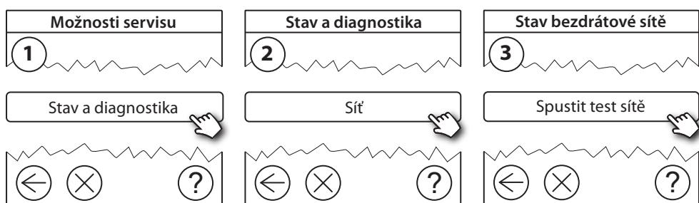
Na konci testu sítě jednotka Danfoss Link™ CC vyčká, až se všechna zařízení napájená bateriemi budí a ohláší se. Postupujte podle pokynů na displeji. Pokud bude test sítě probíhat hladce, nebude potřeba žádných dalších zásahů. Pokud bude test sítě probíhat pomalu, jednotka Danfoss Link™ CC vás provede řešením problémů a nabídne vám užitečné tipy pro zrychlení procesu.
