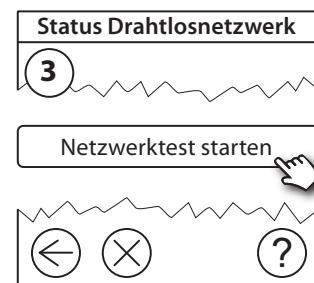
Zum Abschluss des Netzwerktests wartet der Danfoss Link™ CC auf die Einschaltung und Meldung aller batteriebetriebener Geräte. Befolgen Sie die Anweisungen auf dem Bildschirm. Wenn der Netzwerktest problemfrei verläuft, muss nichts mehr unternommen werden. Wenn der Netzwerktest langsam verläuft, führt Sie der Danfoss Link™ CC durch die Fehlerbehebung und gibt Ihnen nützliche Tipps zur Beschleunigung des Ablaufs.
