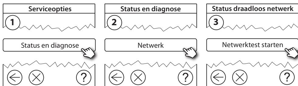
Aan het einde van de netwerktest wacht de Danfoss Link™ CC tot alle apparaten op batterijvoeding geactiveerd zijn en zich hebben gemeld. Volg de instructies op het scherm. Als de netwerktest vlot verloopt, is geen verdere interactie nodig. Als de netwerktest langzaam verloopt, leidt de Danfoss Link™ CC u door de probleemoplossingsprocedure en krijgt u nuttige tips om het proces vlotter te laten verlopen.
