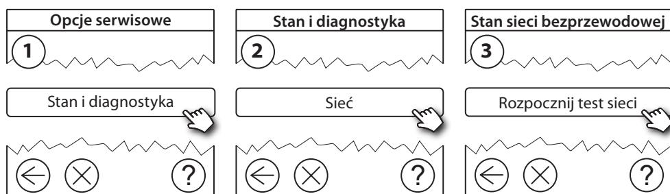
Pod koniec testu sieci panel centralny Danfoss Link™ CC czeka, aż wszystkie urządzenia zasilane baterijnie zostaną wybudzone i zgłoszą się. Postępuj według instrukcji wyświetlanych na ekranie. Jeśli test sieci będzie przebiegał bez problemów, nie trzeba będzie wykonywać już innych czynności. Jeśli test sieci jest wykonywany powoli, panel centralny Danfoss Link™ CC wyświetli instrukcje dotyczące usuwania awarii i użyteczne wskazówki pomagające w przyspieszeniu procesu.
