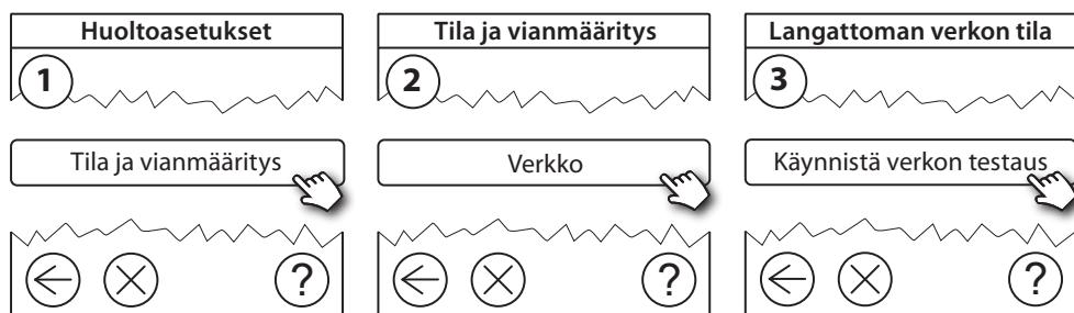
Verkon testauksen lopussa Danfoss Link™ CC odottaa kaikkien paristokäyttöisten laitteiden heräämistä ja ilmoittautumista. Noudata näytössä annettavia ohjeita. Jos verkon testauksessa ei esiinny ongelmia, muita toimia ei tarvita. Jos verkon testaus etenee hitaasti, Danfoss Link™ CC aloittaa ohjatun vianetsinnän ja antaa neuvoja prosessin nopeuttamiseksi.
