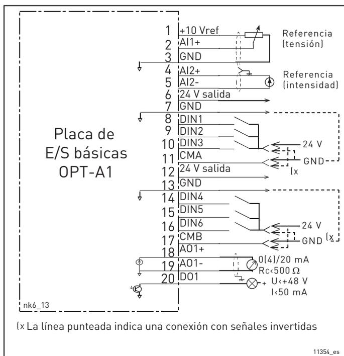
Figura 61. Diagrama de cableado general de la tarjeta de E/S estándar (OPT-A1)
