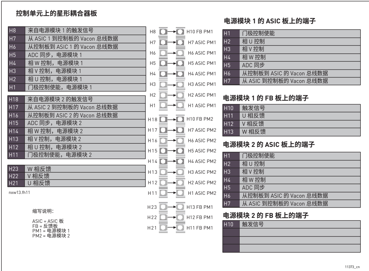
图 76. 星形耦合器板、ASIC 板和反馈板 (CH64 和 CH74) 之间的端子和连接
