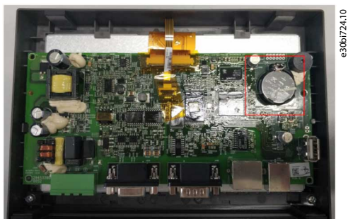
Рисунок 75: Расположение батареи внутри панели оператора
