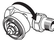
Serrez l'adaptateur RTD manuellement (5 Nm max.).
