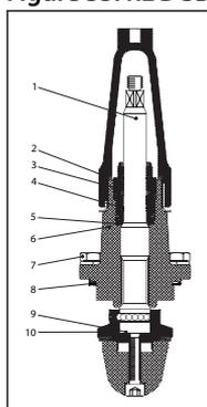
Table 61: REG-SB 50 / REG-SB 65 manual regulating valve module
