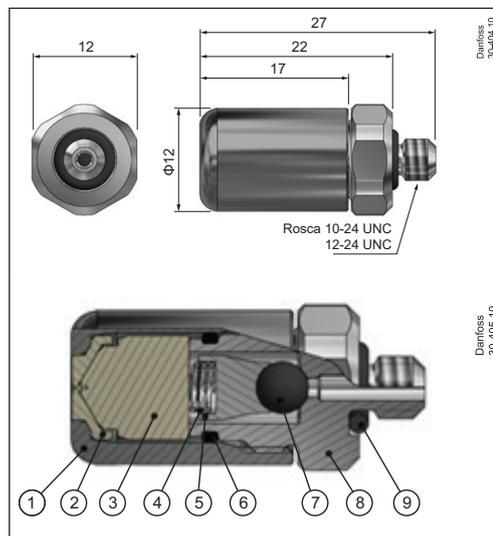
Todas las boquillas se suministran con una válvula incorporada de serie. Con las boquillas antigoteo Slimline, los operarios pueden lograr un corte de fluido cerca del orificio mientras mantienen la presión dentro del sistema de suministro de la boquilla.
