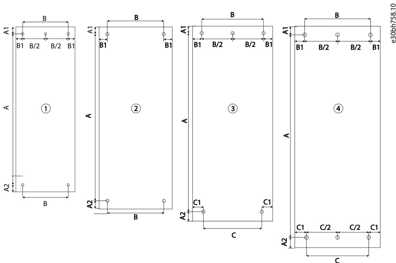
Illustration 41: Schémas de perçage pour les châssis FA02-FA12
