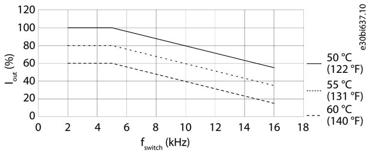
Illustration 30: Déclassement du courant de sortie par rapport à la fréquence de commutation (FA02-FA04) en cas de surcharge faible (LO) et élevée (HO1)
