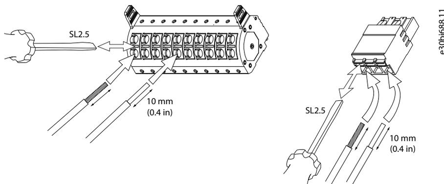
Illustration 59: Insertion des fils dans le connecteur
