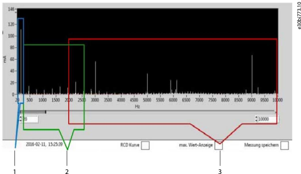
Illustration 47: Exemple de mesure FFT
