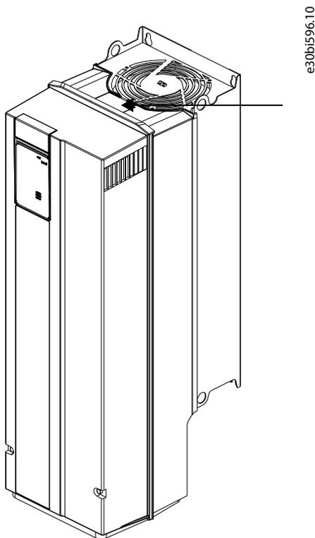
Illustration 22: Emplacement de l'étiquette sur les châssis Fx02-Fx08
