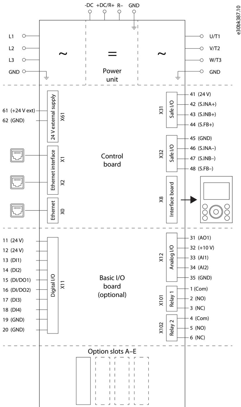
Illustration 46: Schéma de câblage des variateurs de fréquence avec carte de commande Ethernet
