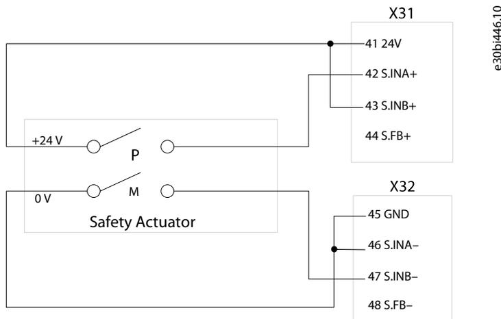
Illustration 62: Exemple de raccordement STO utilisant différentes polarités
