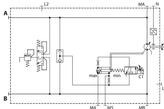
*DIN ISO 3019/2, avec commande proportionnelle électrique*
