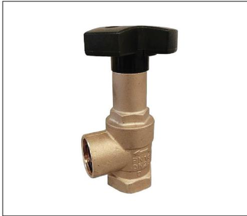
HPBV 是一款自力式压差旁通阀，主要用于空调系统。调节阀平时关闭，当阀前压力超过设定值时开启。
