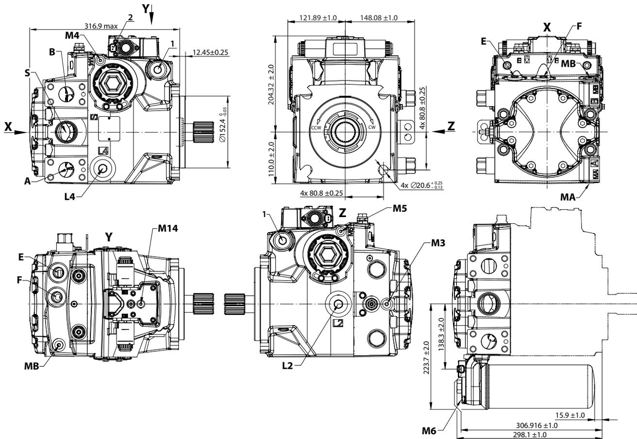
Porte del sistema **A/B**: Ø31.5 mm; M12 x 1.75; 20 min. full thread depth
