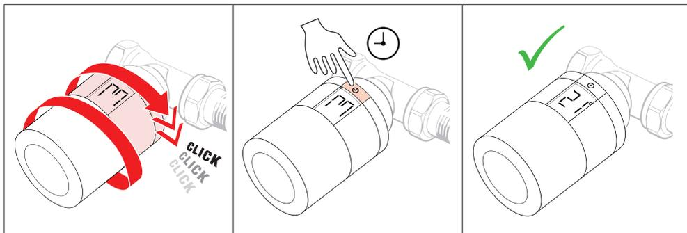
Privijajte termostatsko glavo Danfoss Eco™ na nameščeni adapter, dokler ne slišite zvok zaskočenja. Ko je termostatska glava tesno pritrjena, nastavite zeleno postavitev zaslona. Na zaslonu utripa velika črka **11**, kar pomeni, da je aktiviran način namestitve. Pritisnite gumb in ga držite 3 sekunde.
