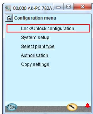
Le régulateur peut uniquement être configuré lorsqu'il est déverrouillé.
