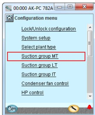
Le menu de configuration dans le Service Tool a maintenant évolué. Il affiche les réglages possibles pour le type d'installation sélectionné.
